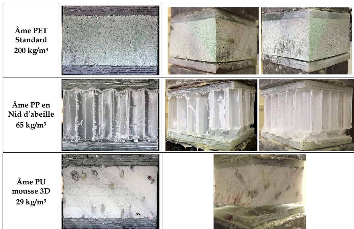
Figure III-134 : Evolution de l'essai de traction perpendiculaire.
