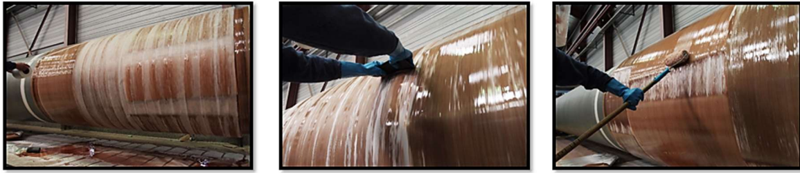
Opérations « Post-Enroulement » : Lissage de la surface extérieure de la structure enroulée
