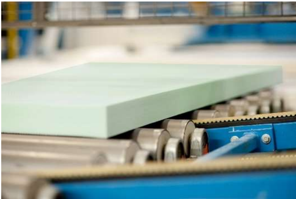
Figure II-69 : Production des âmes ARMAform PET sous forme de plaques planes.
