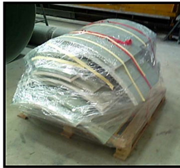
Démoulage du cylindre enroulé, découpage des plaques et mise en palette de l'ensemble (b)
