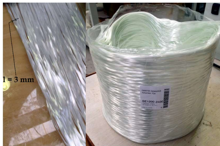
Figure II-96 : Bobine de fibres de verre utilisées pour l'enroulement.
