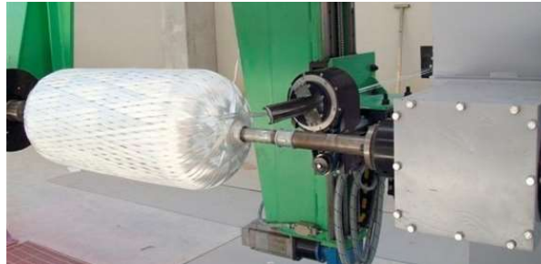
Figure I-41 : Enroulement polaire ou satellite.
