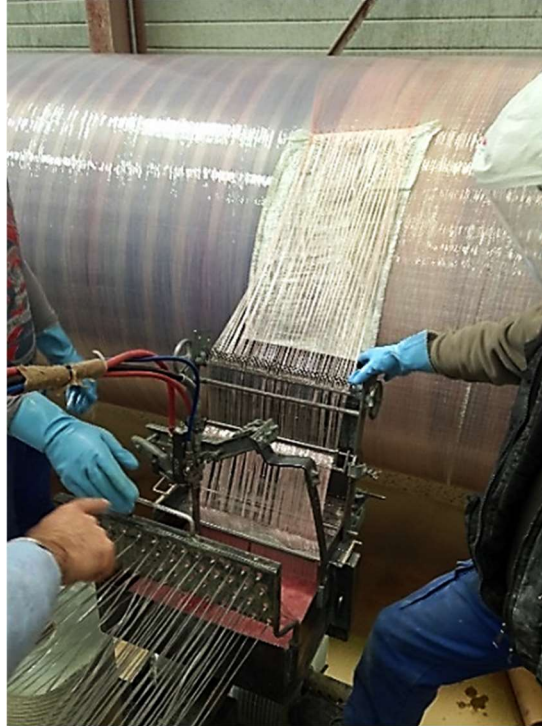
Figure I-39 : Enroulement circconférentiel d'une couche de fibres [Plasticon Composites].
