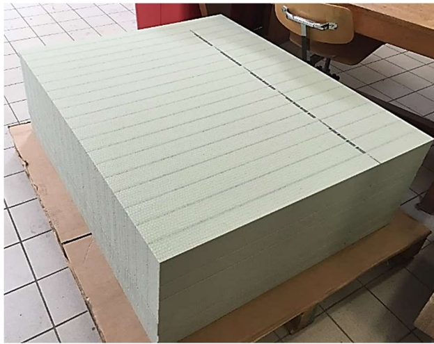
Figure II-83 : Plaques planes en mousse ARMAform PET GR70.
