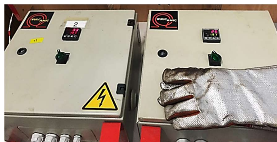
Figure II-86 : Régulateurs de température reliés aux couvertures chauffantes.
