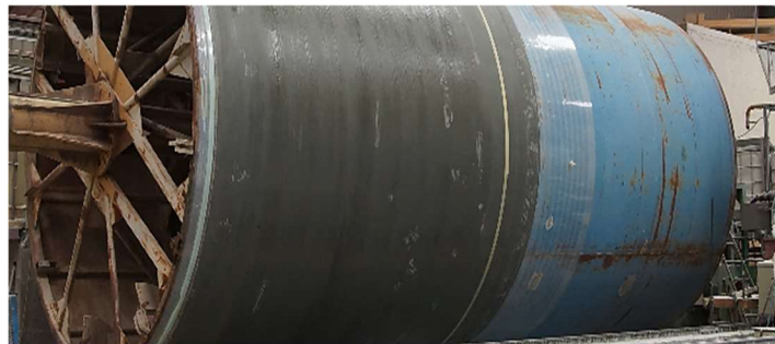
Figure I-38 : Mandrin d'une machine d'enroulement filamentaire [Plasticon Composites].
