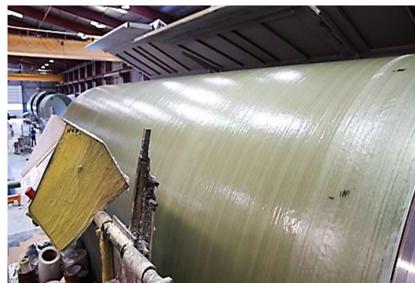
Figure II-49 : Enroulement d'une couche de fibres [Plasticon Composites].
