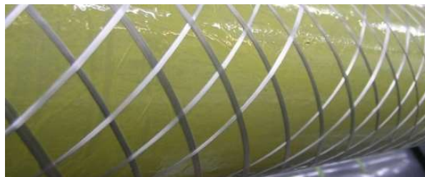
Figure I-40 : Illustration d'un enroulement hélicoïdal à 55^\circ .
