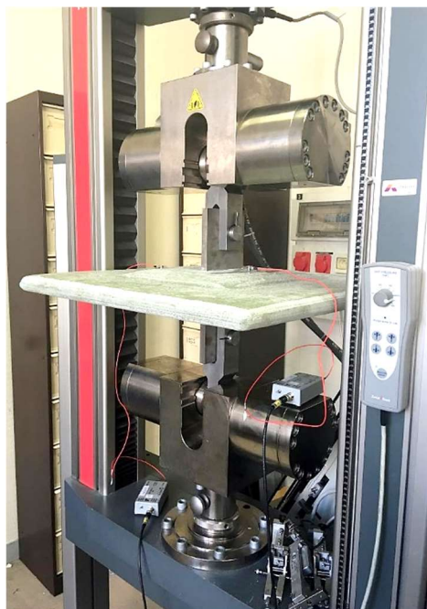
Figure III-184 : Dispositif de l'essai de résistance à l'arrachement.
