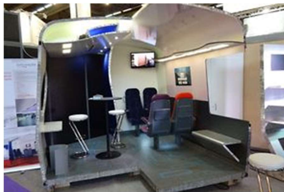
Figure I-8 : Un concept-train en "panneau sandwich".
