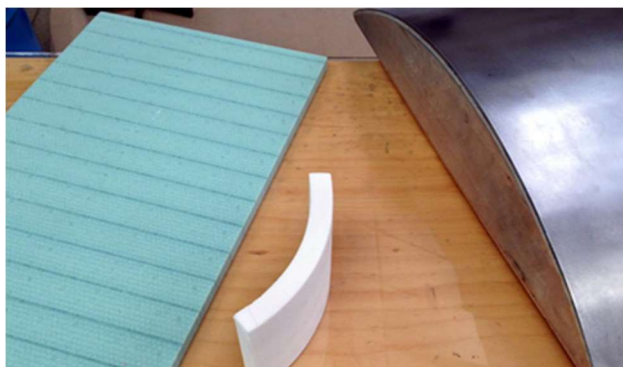
Figure II-84 : Première conception du moule de mise en forme des âmes.
