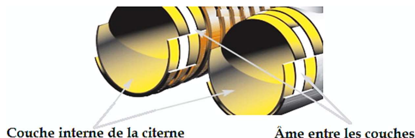
Figure II-60 : Illustration du concept de base de l'enroulement de sandwich.
