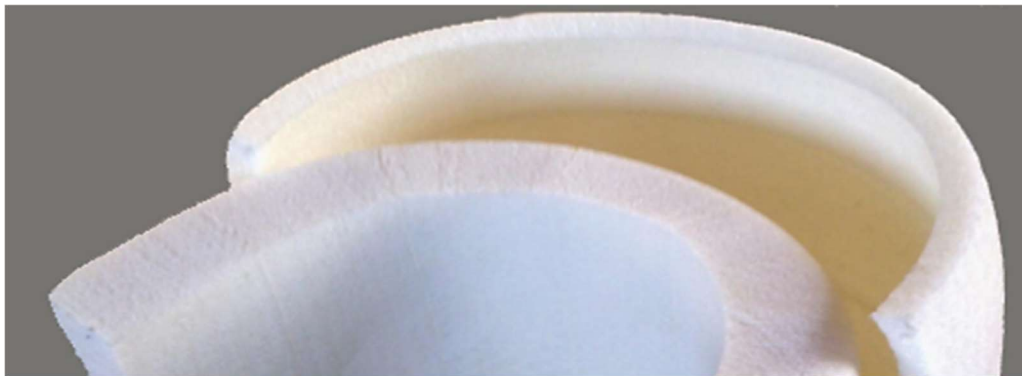
Figure II-70 : Âmes en mousse PET thermoformée avec différentes épaisseurs.
