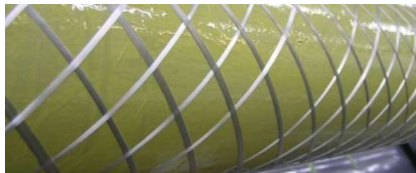
Figure I-40 : Illustration d'un enroulement hélicoïdal à 55^\circ .
