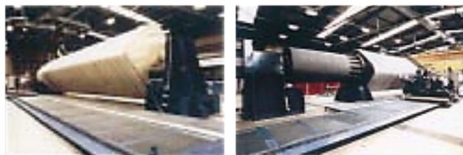
Figure I-46 : Caisses de tramway : pièces sandwich obtenues par enroulement filamentaire [Fabrication Schindler Technik].
