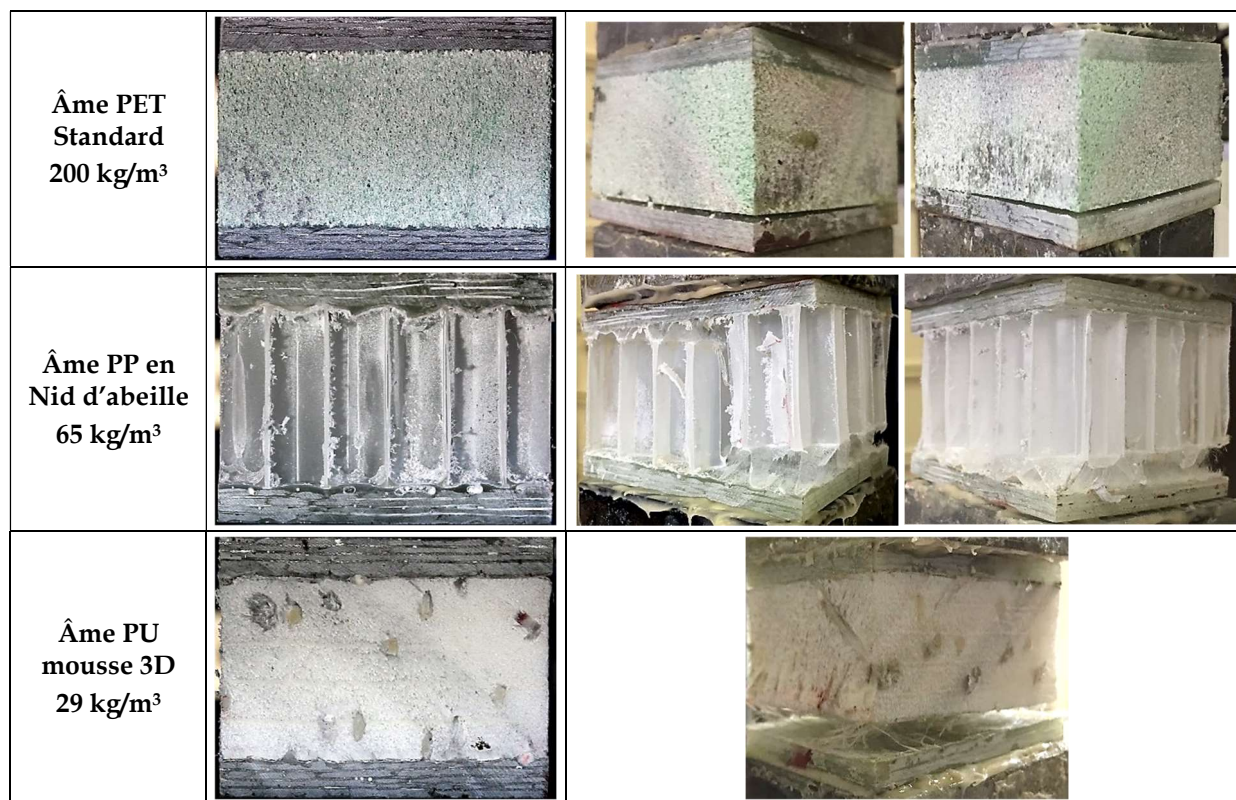
Figure III-134 : Evolution de l'essai de traction perpendiculaire.
