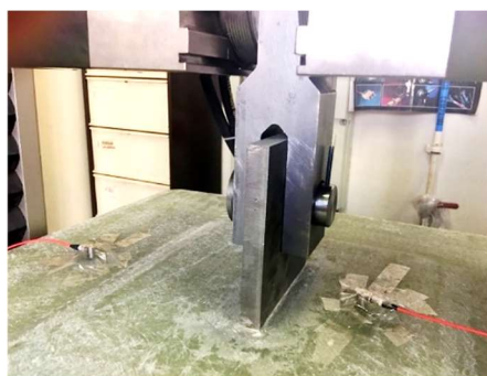
Figure III-186 : Contrôle de l'endommagement par EA pendant l'essai d'arrachement.
