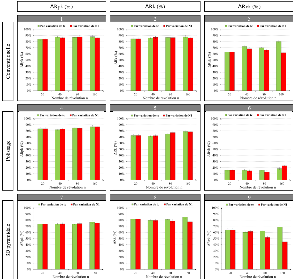
Figure III.14 : Effets de la cinématique sur les critères R_{pk} , R_k et R_{vk} par ajustement distinct du temps de cycle t_c et de la vitesse de rotation N_1
