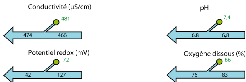
Figure V.10: Comparaison des propriétés physico-chimiques des eaux rejetées des stations d'épuration (en vert) et des propriétés de la Seine en amont et en aval de ces rejets. (a) : station Seine Centre, (b) Seine Aval et (c) : Seine Grésillons. Les flèches représentent le sens d'écoulement de la Seine.
