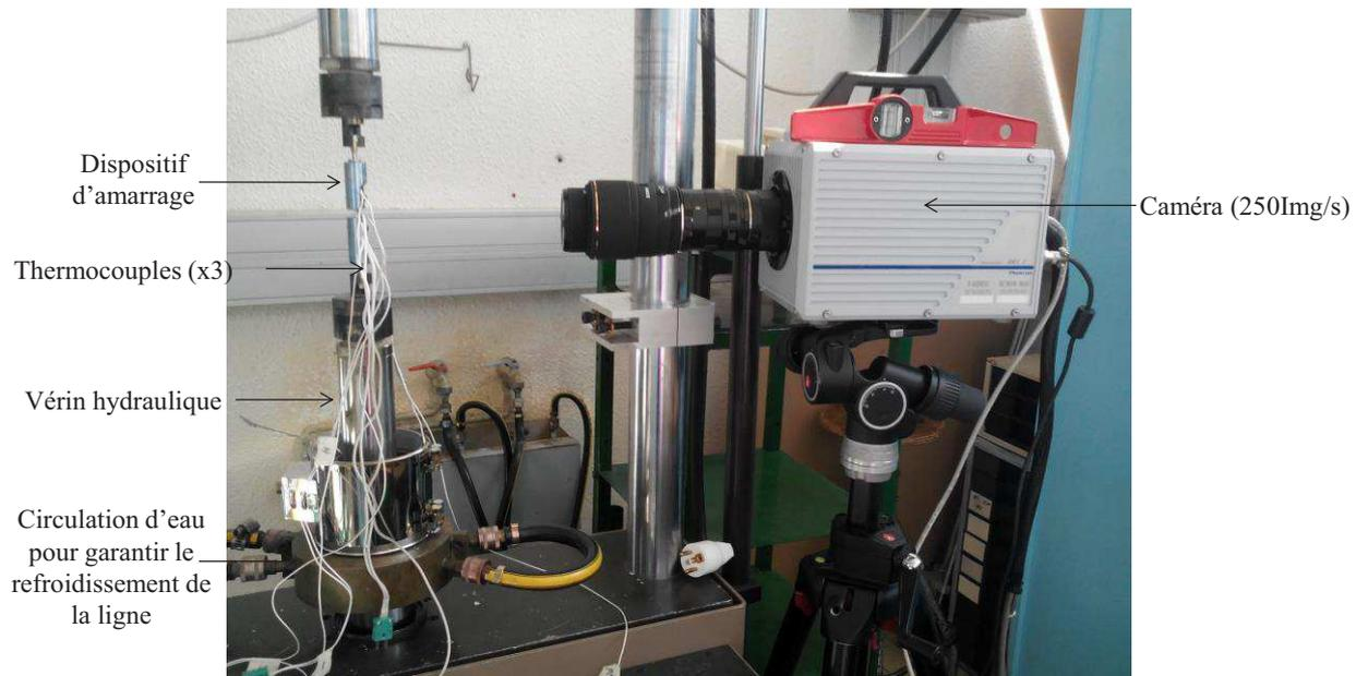
Figure 4.2 : photographie du dispositif de traction axiale.
