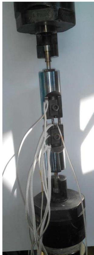
Figure 4.3 : photographie du dispositif d'amarrage de l'éprouvette<sup>1</sup>.
