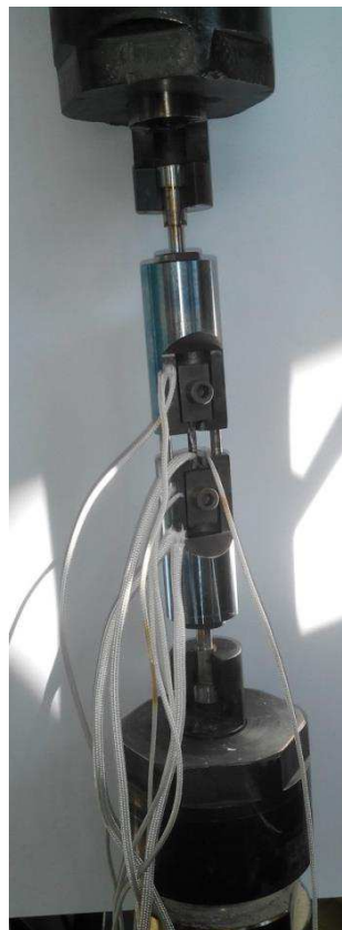
Figure 4.3 : photographie du dispositif d'amarrage de l'éprouvette 1 .
