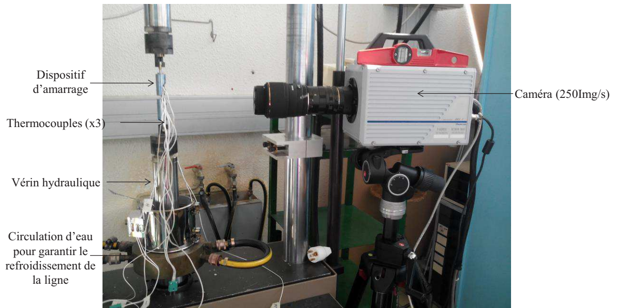
Figure 4.2 : photographie du dispositif de traction axiale.
