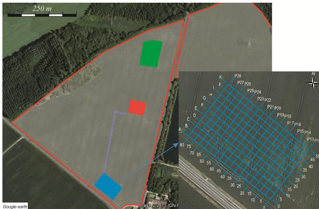
Figure V-34. Implantation des profils de mesure par GPR sur la zone 1 de la gravière des Ormes-sur-Voulzie. Les profils sont espacés de 5 m
