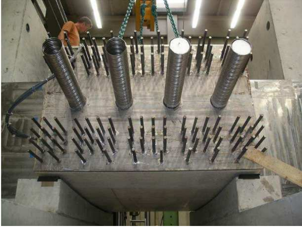
FIGURE 3.5 – Les gaines des quatre câbles de précontrainte horizontaux de l'élément de structure PACE 1450
