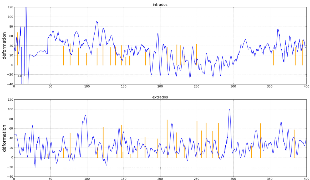
FIGURE 3.28 – Relevé des déformations tangentielles le long des fibres optiques 45 jours après le coulage du gousset.
