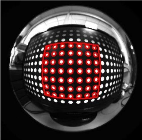
FIGURE E3 – Détection de la zone d'intérêt de la mire de calibration
