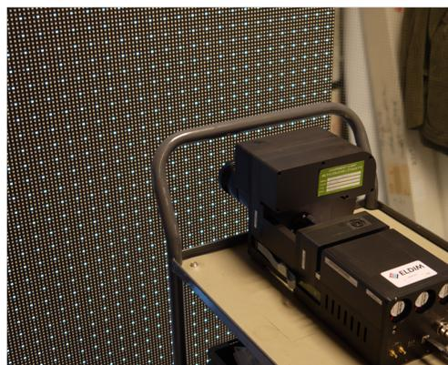
FIGURE 11.13 – Panneau de LEDs avec une périodicité de 8 cm, très précis, utilisé pour la déterminations des différents offsets des filtres.
