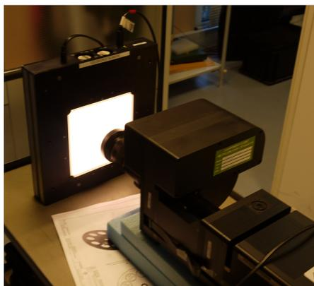
FIGURE 11.15 – Matrice de LEDs stabilisées et diffuseurs compensés pour l'homogénéité dans l'axe optique.
