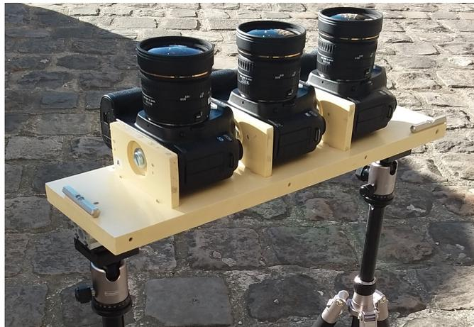
FIGURE 10.4 – Système de capture HDRI polarisée
