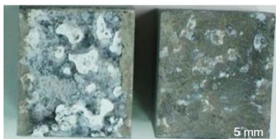
Figure 3.5 : vue des surfaces de séparation, côté pâte de ciment (gauche) et côté argilite (droite) présence de phases blanches et bleues
