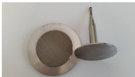
FIGURE 2.7 – Géométrie Plan / Plan.  $R = 25$  mm.
