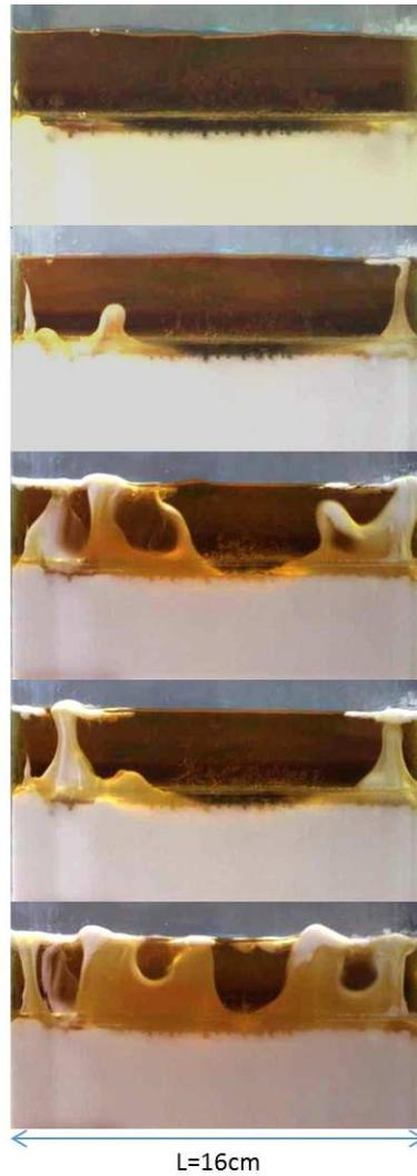
FIGURE 3.6 – Développement de l'instabilité de Rayleigh-Taylor dans le cas d'un fluide à seuil en contact avec un fluide newtonien : de l'émulsion inverse en-dessous d'une solution d'iodure de sodium, aux instants 0, 1.9, 3, 3.8 et 4.5 s.
