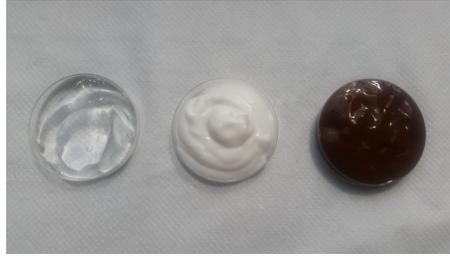
FIGURE 2.2 – Fluides à seuil utilisés. De gauche à droite : Gel de carbopol, Emulsion, Spacer. La cuvette fait 3 cm de diamètre et les tas ont une hauteur de 5 mm environ.
