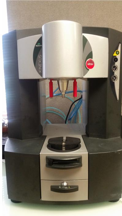
FIGURE 2.6 – Rhéomètre Ultra+ de Malvern
