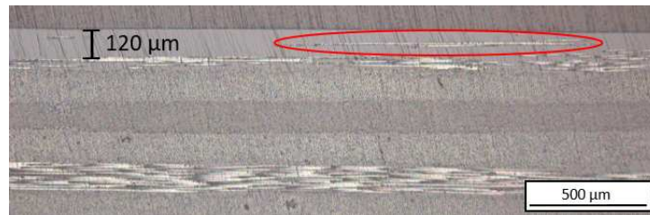
FIGURE 6.1 – Vue en coupe (MO) d'un film de 100 \mu\text{m} de PEEK sur un substrat APC2/AS4
