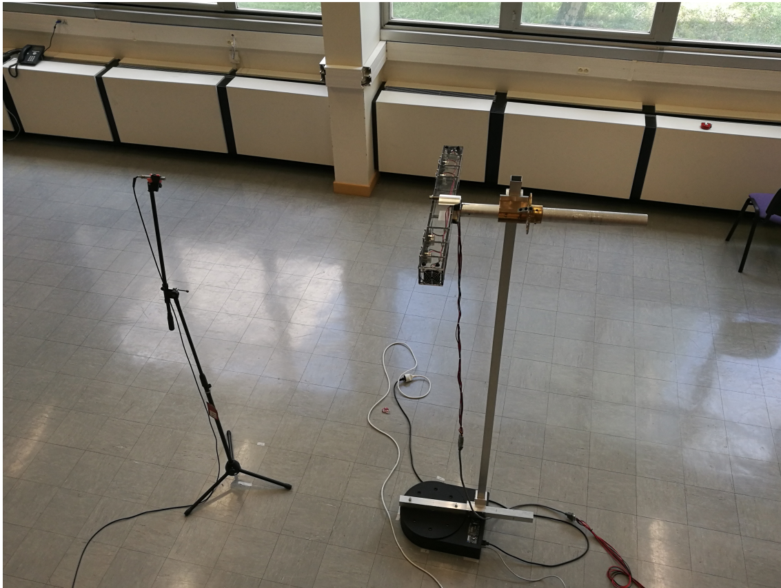
Figure I.2.2 – Partie du montage de mesure. Les angles \theta_1 et \theta_2 sont dans leurs positions d'origine. On peut voir le micro, la barre de son, la table tournante, ainsi que la structure avec la roue à cliquet sur laquelle est montée la barre. L'ampli, l'ordinateur et la carte d'acquisition sont déportés dans une autre pièce, pour limiter la pollution sonore. La salle n'est pas traitée acoustiquement.
