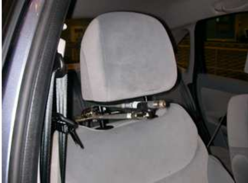
FIGURE 1.2 – Micro utilisé pour la mesure de bruit à l'intérieur du véhicule
