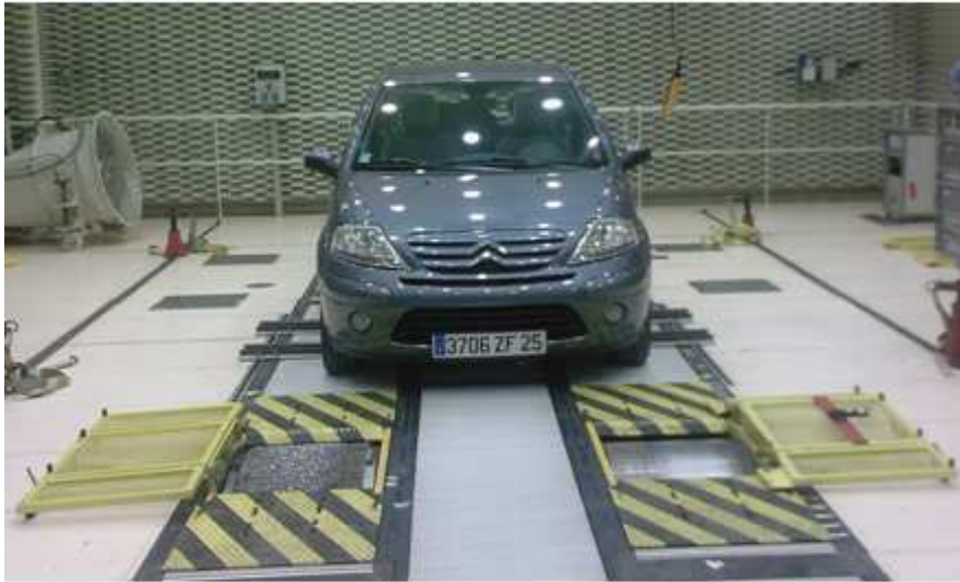
FIGURE 1.3 – Illustration du banc à rouleaux chez PSA Peugeot Citroën
