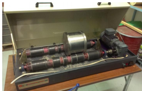
FIGURE 6.4 – Dispositif du test de Micro Deval : appareil avec un seul cylindre. il est possible de faire tourner jusqu’à 4 cylindres simultanément
