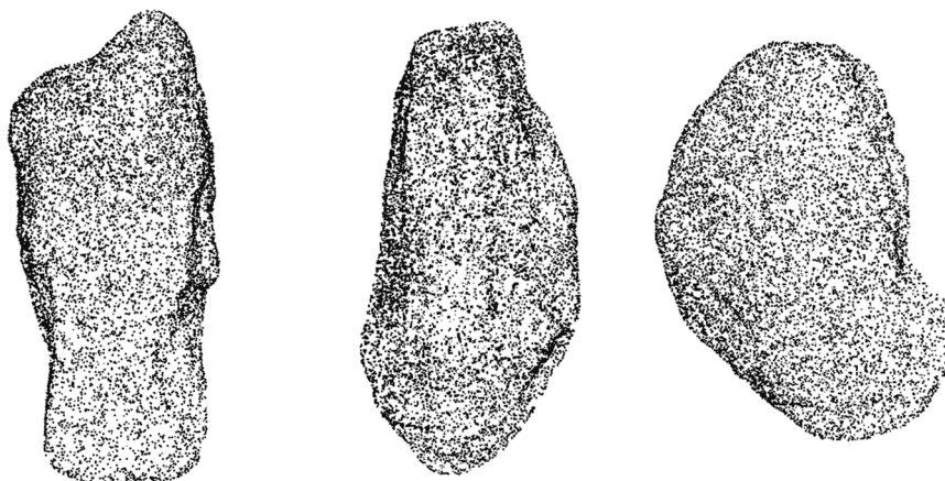
FIGURE 6.6 – Exemple de trois grains obtenus par scan 3D de grains à différents degrés d'usure : neuf(a) ; usé à 70 min au (MD) (b) ; usé à 140 min au (MD)
