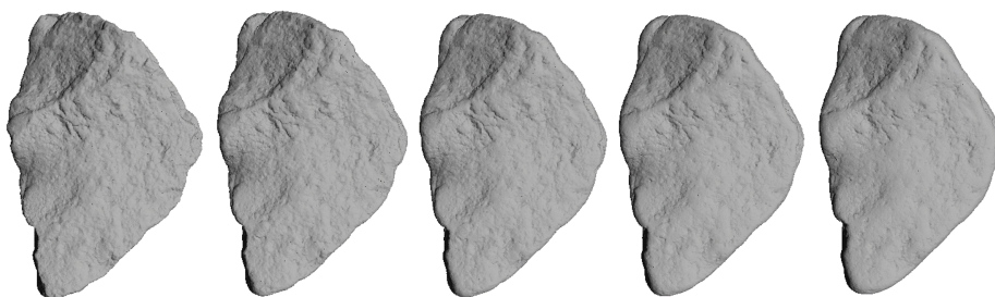
FIGURE 6.14 – scan 3D de 5 degrés d’usures du même grain de ballast. De gauche à droite, une usure croissante au Micro Deval : 0 min, 10 min, 30 min, 70 min et 140 min.
