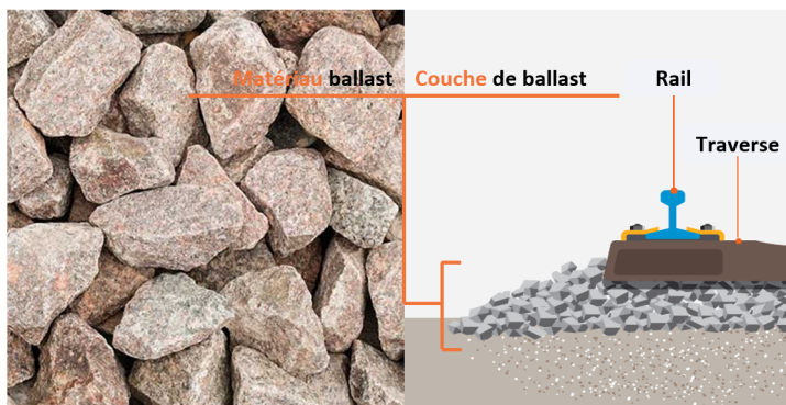
FIGURE 1.6 – Le ballast : le matériau (gauche), et la structure couche dans la voie(droite)
