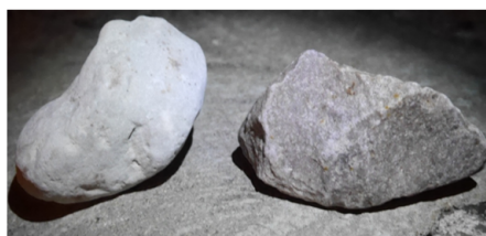
FIGURE 6.1 – Grain de ballast usé (gauche) et neuf (droite).
