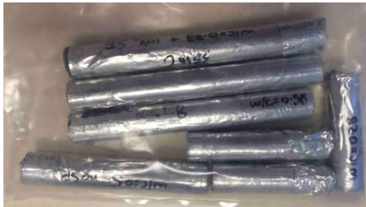
Figure 2.8 – Photo des 7 échantillons utilisés dans cette étude. Certains échantillons ont déjà été utilisés dans la thèse de Zhang, leur hauteur est donc inférieure à 160 mm.
