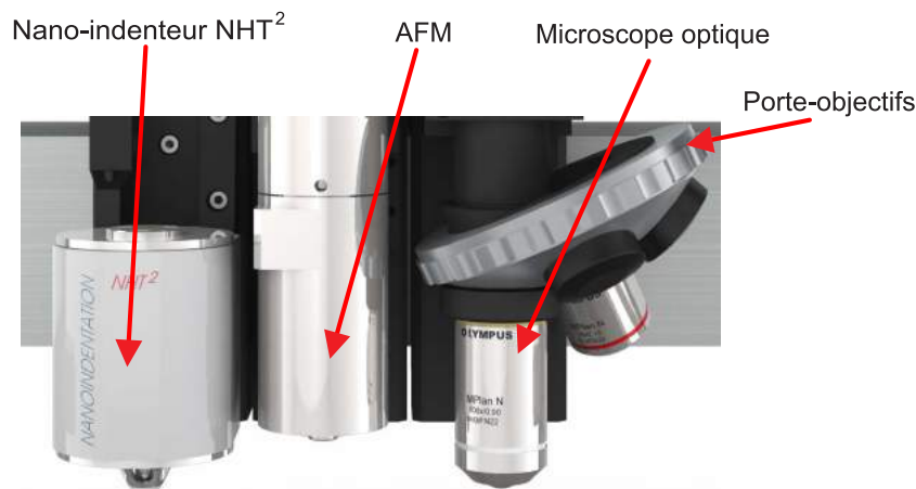
Figure A.5 – Disposition de la tête d'indentation, du microscope optique et de l'AFM
