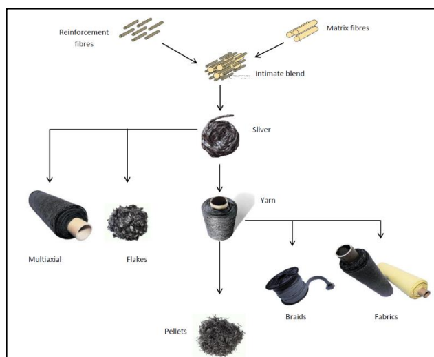
Figure 4 : Fabrication fibres co-mêlées craquées et leur utilisation
