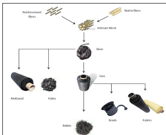
Figure 4 : Fabrication fibres co-mêlées craquées et leur utilisation
