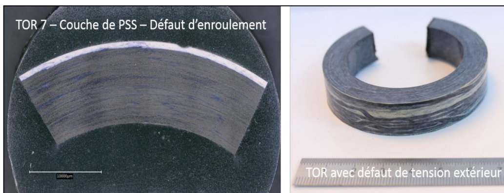
Figure 21 : Défauts caractéristiques d'un mauvais remplissage
