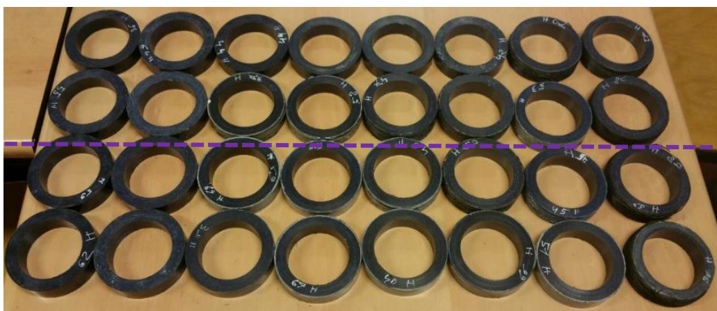
Figure 6 : Ensemble des 32 pièces réalisées pour le plan d'expérience TAGUCHI
