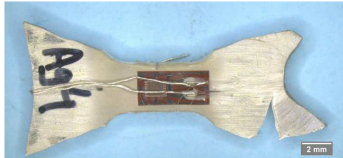
Figure 4 - 19 : Eprouvette et sa jauge de contrainte après traction
