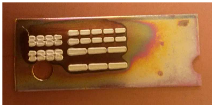
Figure 2 - 1 : Action anti-oxydante dans la pâte à fritter n°1 sur une plaque de cuivre
