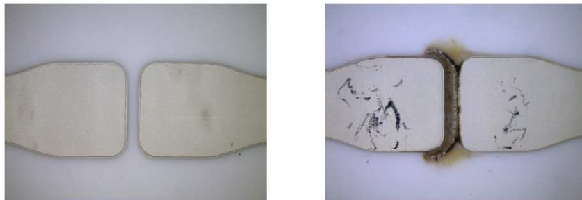
Figure 1 - 34 : Structure de test en frittage d'argent permettant de faire migrer l'argent sous l'effet d'un champ électrique. Cette structure de test est représentée avant (à gauche) et après (à droite) migration [40]
