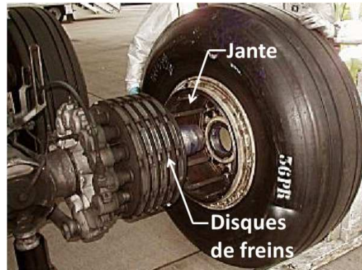
Figure 1 - 2 : Proximité de la jante et des disques de freins sur un Airbus A340 [2]
