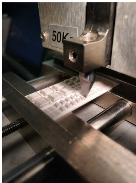
Figure 4 - 39 : Photo d'un essai de cisaillement
