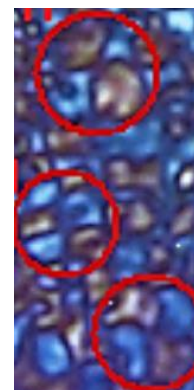
Figure 63: Photographie du cœur d'une plaque injectée polyamide 66 : insertion d'une lame de gypse
