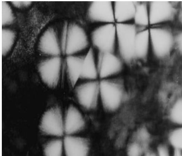
Figure 10: Second exemple de cristallisation en sphérolite d'un film polyamide 66 [24]
