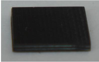
FIGURE 4.4 – Cible de composite IMA/M21E usiné aux dimensions adaptées à l’installation GCLT - Epaisseur  $1000 \mu m$  - Empilement  $0^\circ/90^\circ/0^\circ/90^\circ/0^\circ$  - Dimensions latérales  $8 mm \times 8 mm$
