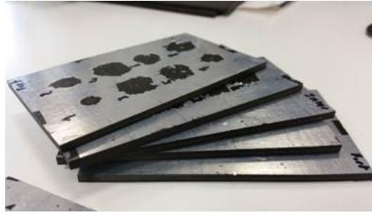
FIGURE 5.3 – Assemblage Composite stratifié-croisé/Epoxy/Composite stratifié-croisé post-choc - Epaisseur  $1800\ \mu\text{m}/150\ \mu\text{m}/1300\ \mu\text{m}$  - Dimensions latérales  $100\ \text{mm} \times 60\ \text{mm}$
