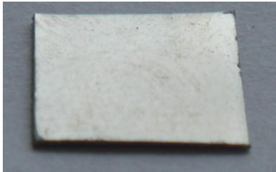
FIGURE 4.3 – Cible de TA6V4 usinée aux dimensions adaptées à l’installation GCLT - Epaisseur  $520 \mu m$  - Dimensions latérales  $8 mm \times 8 mm$
