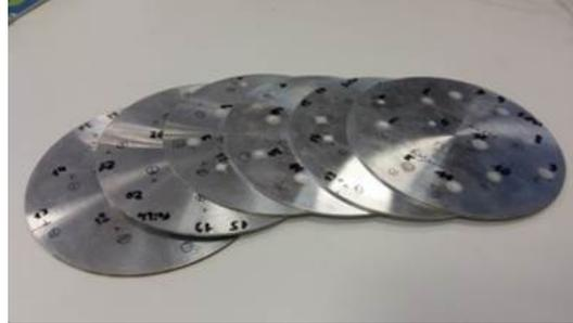
FIGURE 5.1 – Assemblages Aluminium 6061 / Epoxy /Aluminium 6061 post-choc - Epaisseur  $800\ \mu m/150\ \mu m/600\ \mu m$  - Diamètre  $\phi 125\ mm$
