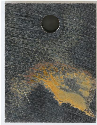
FIGURE 5.37 – Aperçu d'un échantillon thermobalance après 7 jours de temporisation sous air.
