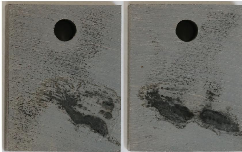
FIGURE 5.39 – Aperçu de l'échantillon thermobalance après pollution longue sous air et traitement de nitruration.
