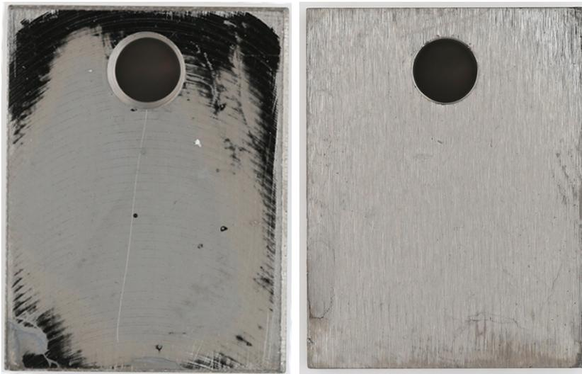
FIGURE 5.29 – Aperçu de l'échantillon contaminé par solution aqueuse de sulfate d'ammonium et nitruré 5 h.
