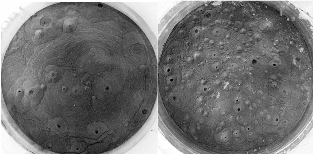
Figure 1-9: Illustration des canaux d'extraction d'eau à la surface du tube à la fin du ressuage de la pâte de référence : Deux cas extrêmes de 5 essais réalisés dans des conditions identiques (contraste artificiellement amélioré).
