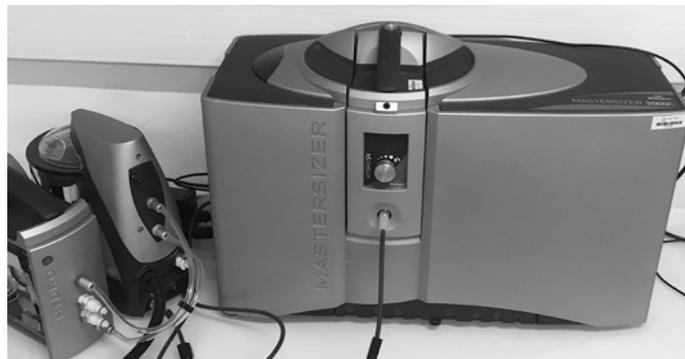
*Figure 3-5 : Granulomètre Laser Mastersizer 3000E de Malvern Instruments*
