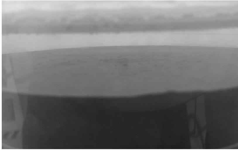
Figure 1-10: Illustration de la surface du tube à la fin du ressuage d'une pâte de ciment de E/C de 0,4
