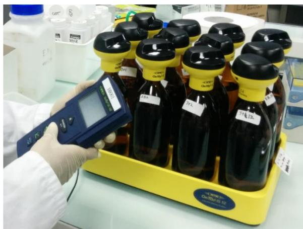
Figure 22 : Photographie du système Oxitop® utilisé pour la définition de la DBO ultime
