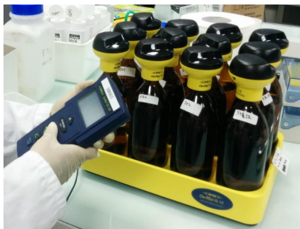
Figure 22 : Photographie du système Oxitop® utilisé pour la définition de la DBO ultime
