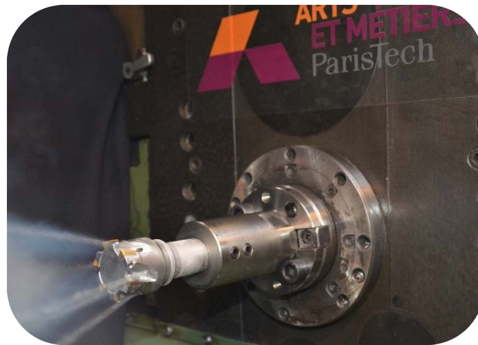
Figure 4.3 : Assistance cryogénique en fraisage par centre broche (développement LaBoMaP)
