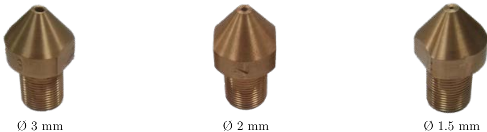
Figure 2.19 : Buses de projection de LN 2 coniques et fabriquées en interne
