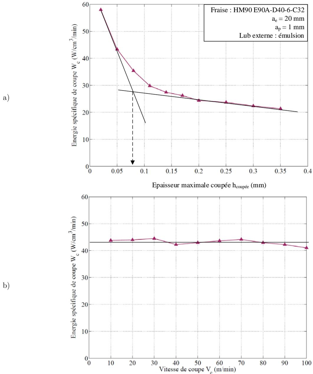
Figure 4.7 : Evolution de l'énergie spécifique de coupe  $W_c$  (W/cm<sup>3</sup>/min) en fonction de :
