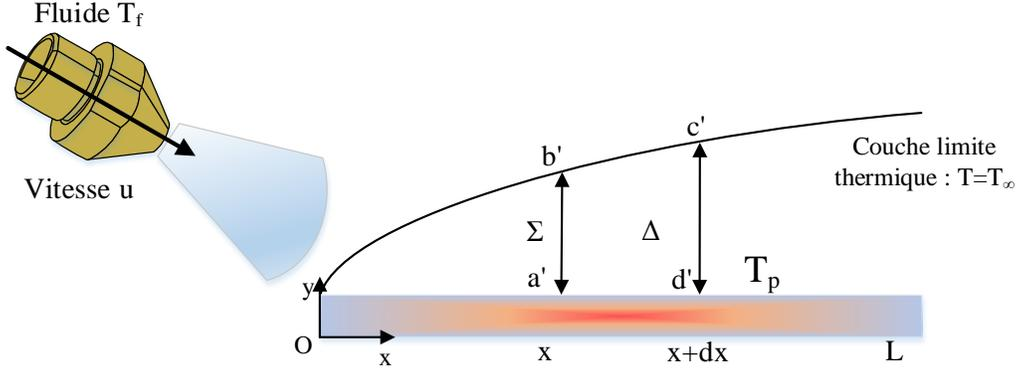
Figure 2.5 : Couche limite thermique sur une plaque plane
