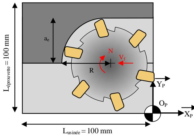
Figure 4.8 : Schématisation des essais de fraisage du Ti6Al4V
