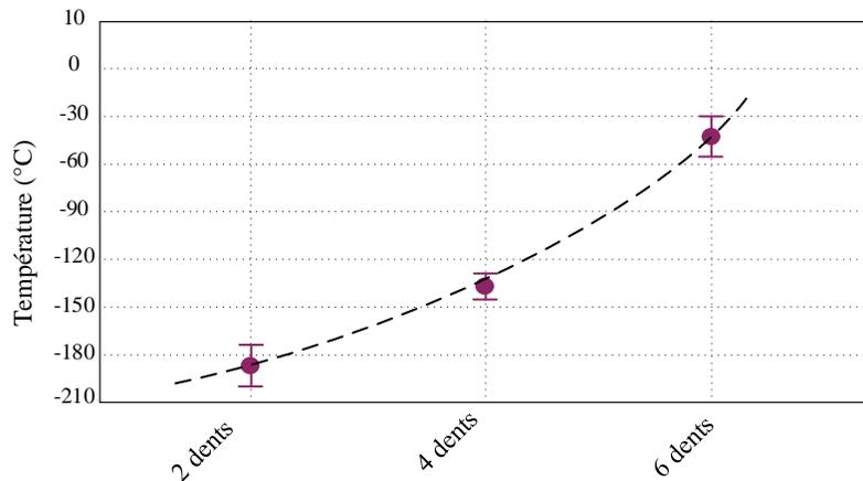
**Figure 3.16** : Evolution de la température mesurée par TC<sub>2</sub> en fonction du nombre de créneaux.
