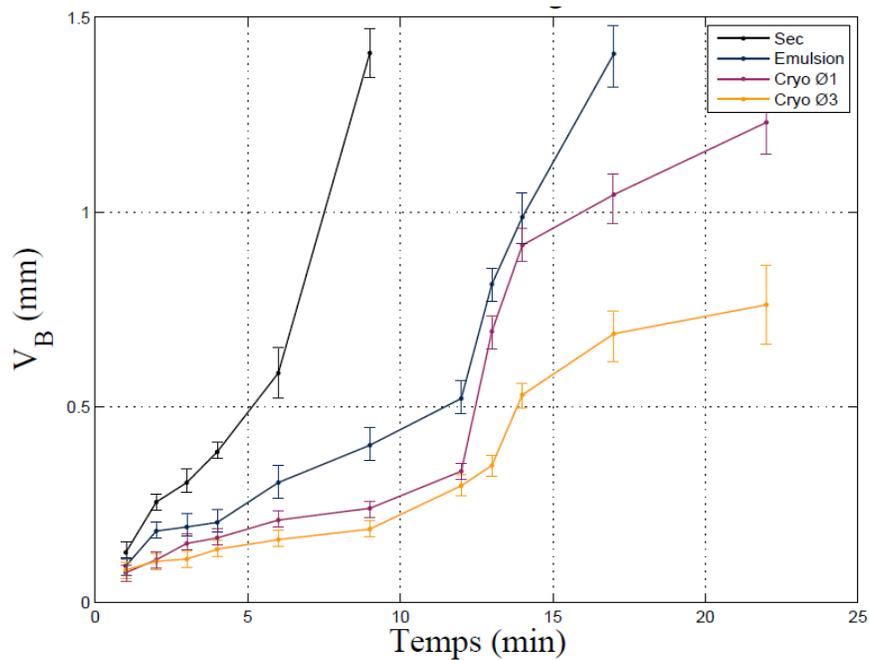
Figure 4.17 : Usure en dépouille en fonction du temps
