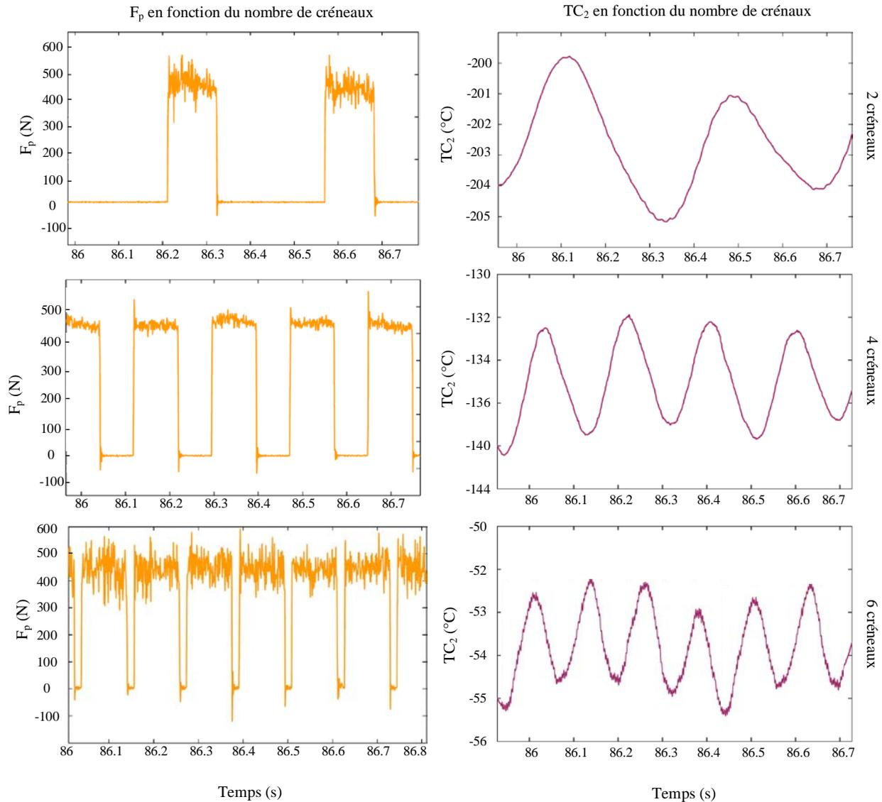
**Figure 3.15** :  $F_p$  et  $TC_2$  en fonction du nombre de créneau ; Chariotage discontinu,  $V_c = 30\text{ m/min}$ ,  $f = 0.2\text{ mm/tr}$  et  $a_p = 1\text{ mm}$  avec  $\text{LN}_2\text{ } \varnothing 3\text{ mm}$
