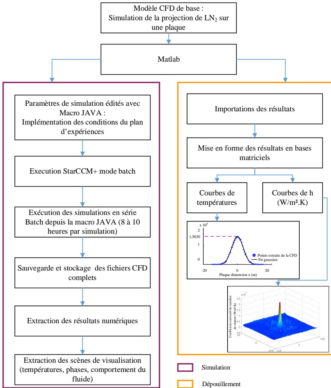
Figure 2.25 : Routine d'automatisation des simulations CFD
