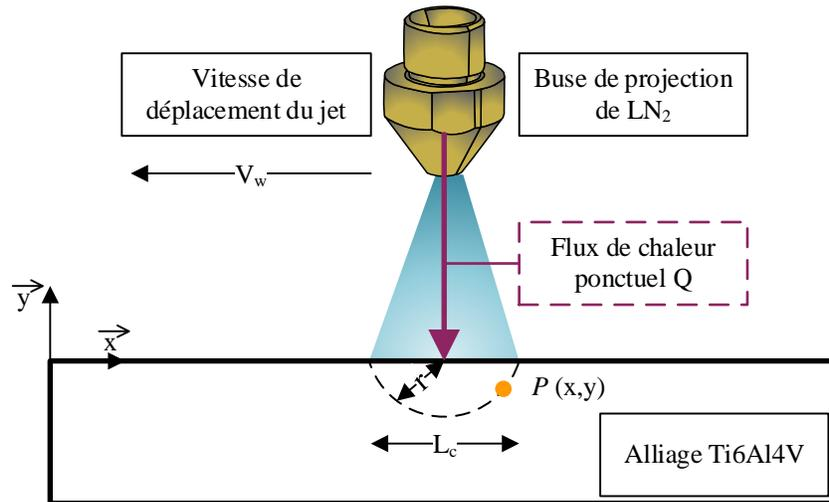
Figure 1.7 : Projection d'azote liquide sur une paroi
