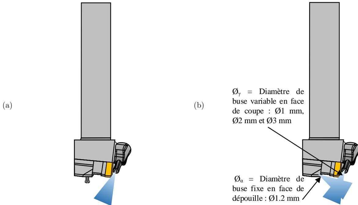
Figure 3.5 : Stratégie de pulvérisation du LN<sub>2</sub> pour le tournage en chariotage du Ti6Al4V ; outil PCLNL - 12 modifié pour assistance cryogénique ; a) Projection face de coupe ; b) Projection face de coupe + dépouille
