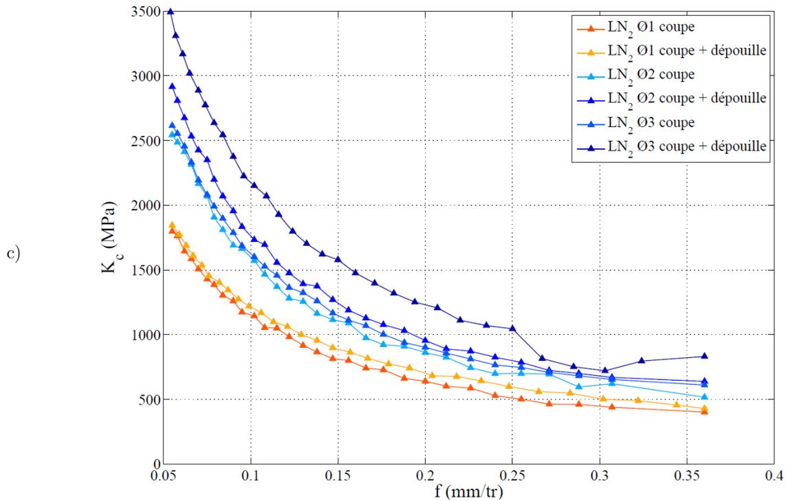
Figure 3.6 : Evolution de  $K_c$  (MPa) en fonction des paramètres d'assistance à l'usinage en avance continue avec :  $a_p = 1$  mm ;  $V_c = 55$  m/min ; a) comparaison sec/émulsion ; b) comparaison sec/LN<sub>2</sub> Ø1 mm ; c) comparaison LN<sub>2</sub> Ø1 mm/LN<sub>2</sub> Ø2 mm/LN<sub>2</sub> Ø3 mm
