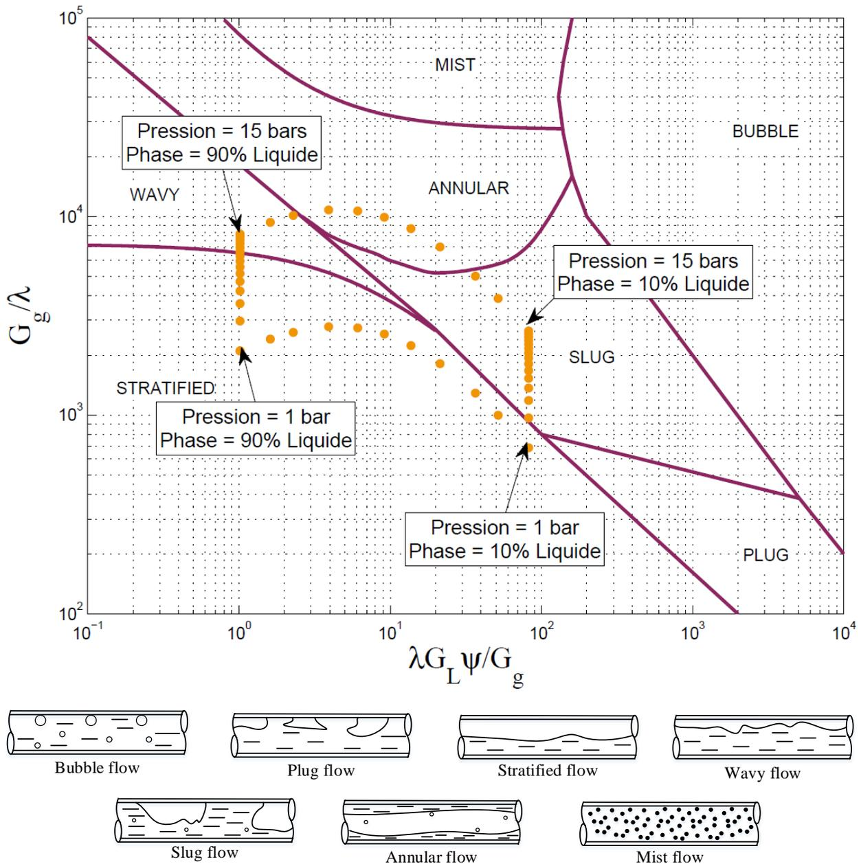
Figure 2.7 : Diagramme de Baker d'un écoulement horizontal de LN<sub>2</sub> [Barron 99]
