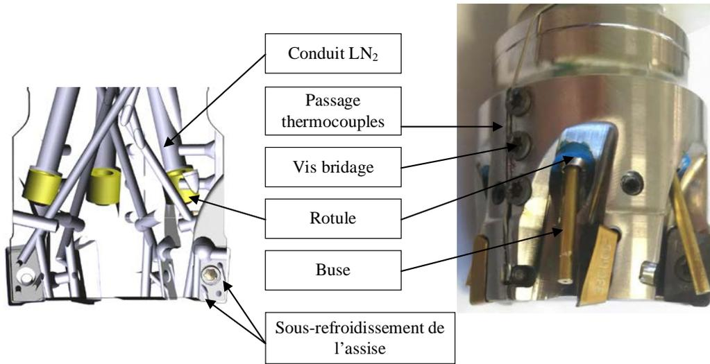
Figure 4.4 : Fraise instrumentée avec assistance cryogénique
