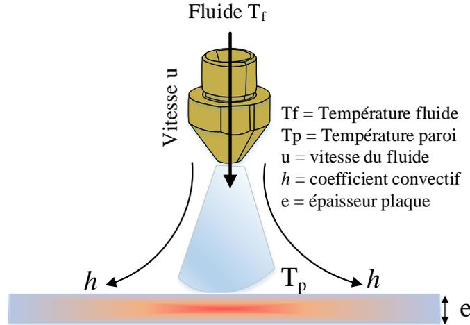
Figure 2.3 : Schématisation du transfert de chaleur par convection
