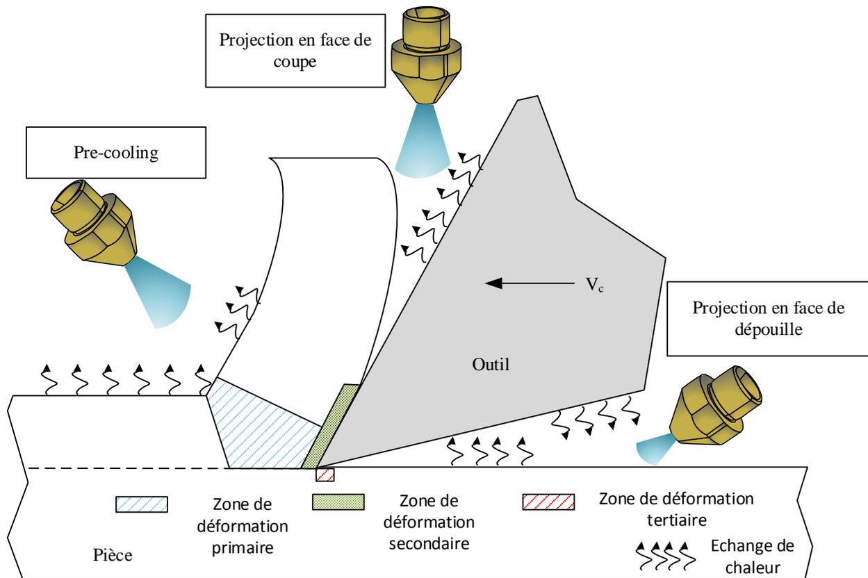
Figure 2.15 : Source de chaleur générée par la coupe et application de LN<sub>2</sub>
