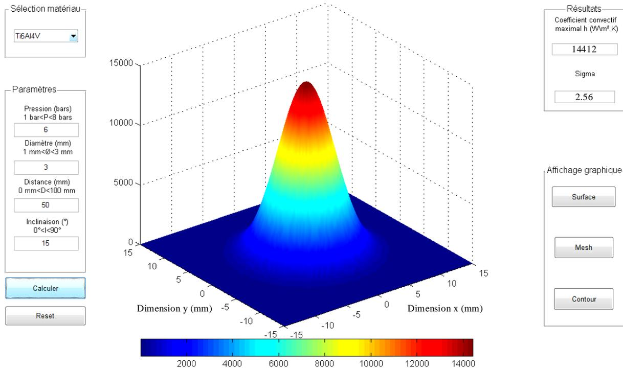
Figure 2.36 : Exécutable graphique de calcul de  $h$  ( $W/m^2.K$ )
