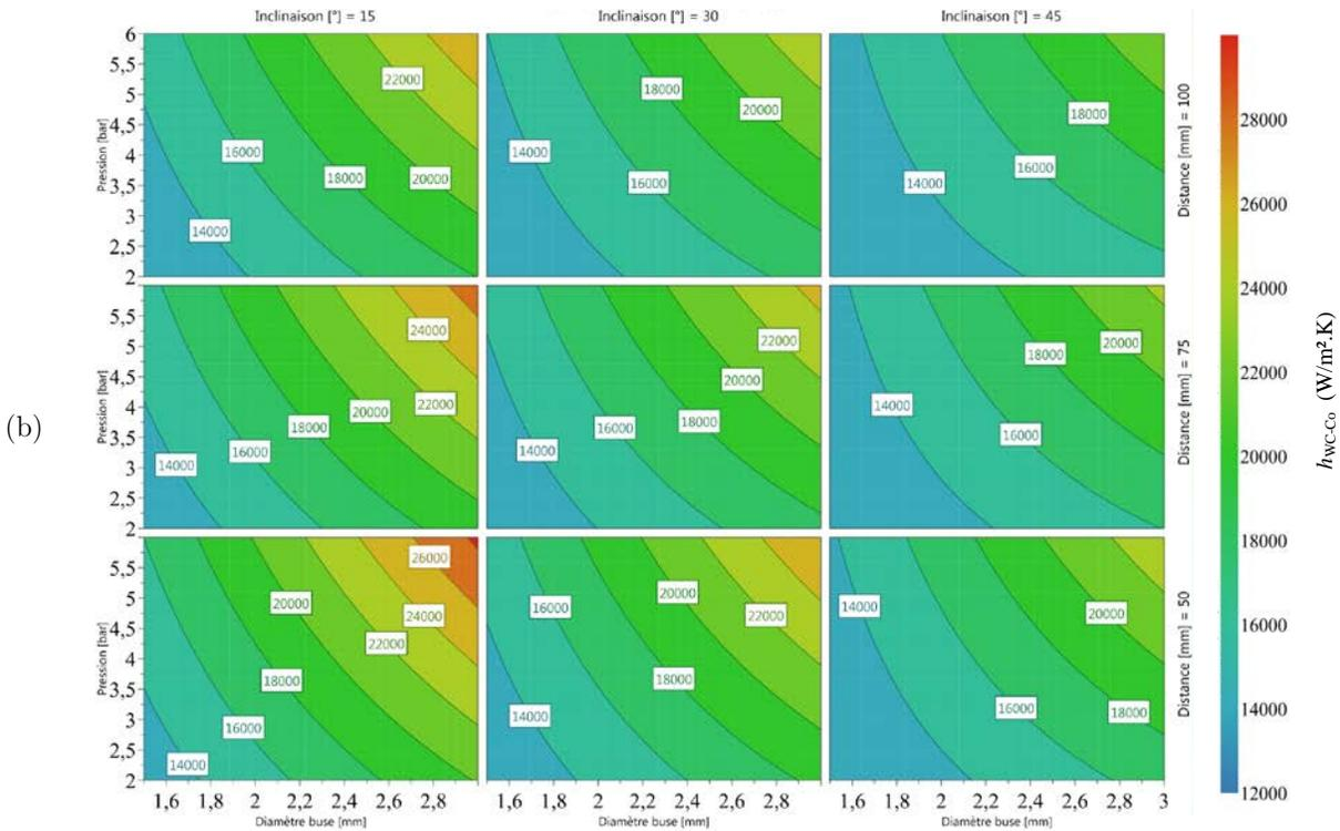
Figure 2.31 : Contour 4D ; (a)  $h_{Ti6Al4V}$  ( $W/m^2.K$ ) ; (b)  $h_{WC-Co}$
