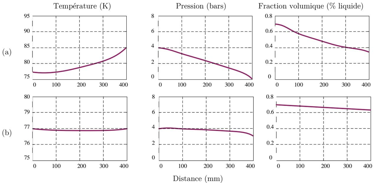
**Figure 2.9** : Evolution de la température, de la pression et de la fraction volumique en fonction de la position dans le tube de LN<sub>2</sub>. (a) Régime transitoire (à  $t = 20$  s) ; (b) Régime permanent (à  $t = 200$  s).
