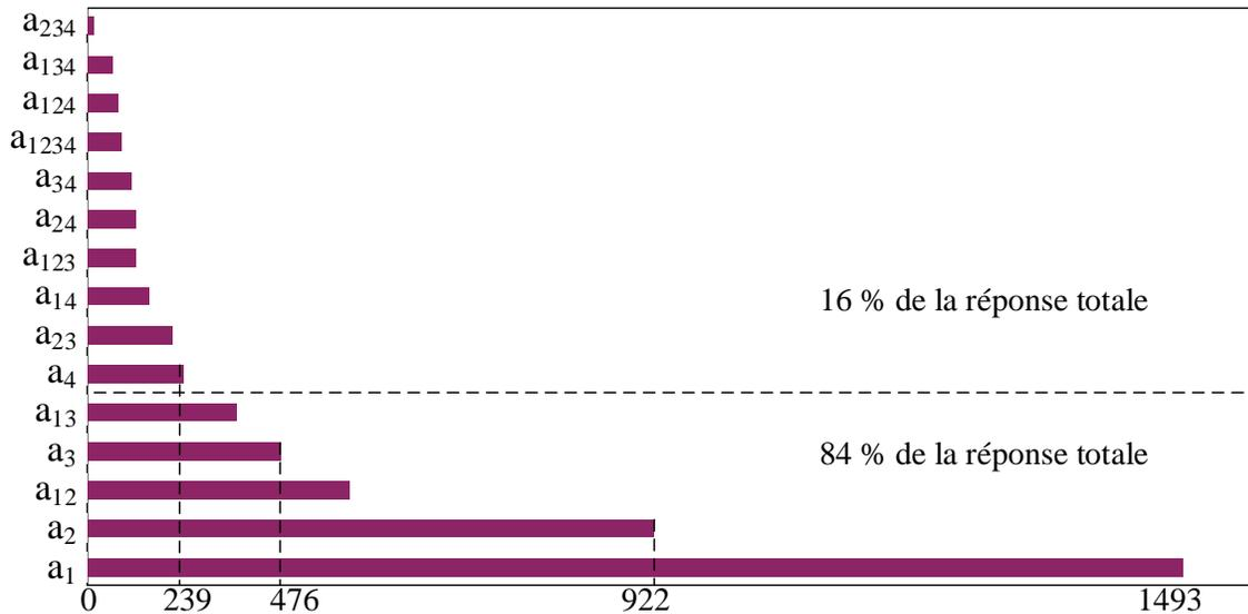
Figure 2.28 : Diagramme de Pareto des coefficients en valeur absolue du modèle polynomial pour le Ti6Al4V
