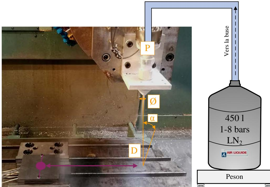
Figure 2.18 : Illustration du montage expérimental de projection de LN<sub>2</sub> sur plaque
