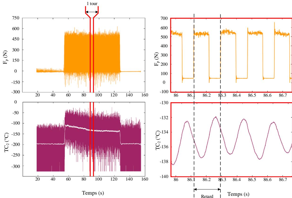
[Figure 3.14](#) : Essai de chariotage discontinu avec zoom en milieu d'essai sur 1 tour d'éprouvette 4 dents avec projection de  $LN_2$   $\varnothing 3$  mm ;  $V_c = 30$  m/min,  $f = 0.2$  mm/tr et  $a_p = 1$  mm
