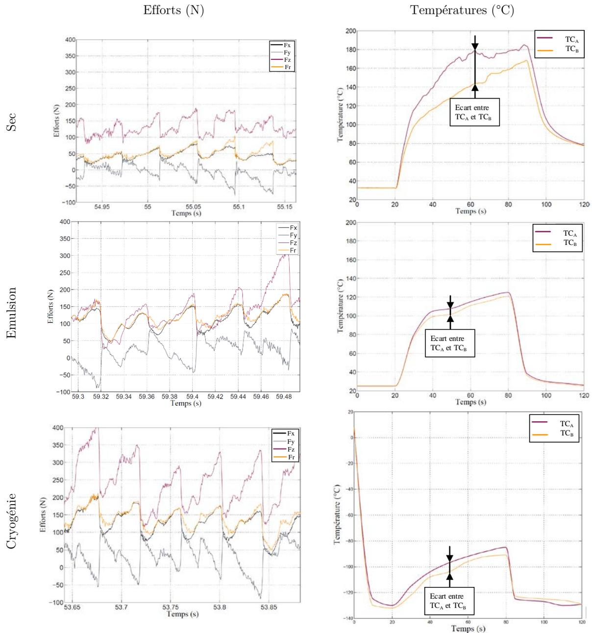
Figure 4.10 : Présentation des essais réalisés en surfacage à sec, avec émulsion et LN<sub>2</sub> avec buse de Ø1 mm ;  $V_c = 30$  m/min ;  $f_z = 0.1$  mm/dent ;  $a_p = 1$  mm.
