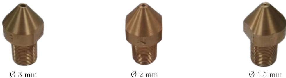
[Figure 2.19](#) : Buses de projection de LN<sub>2</sub> coniques et fabriquées en interne
