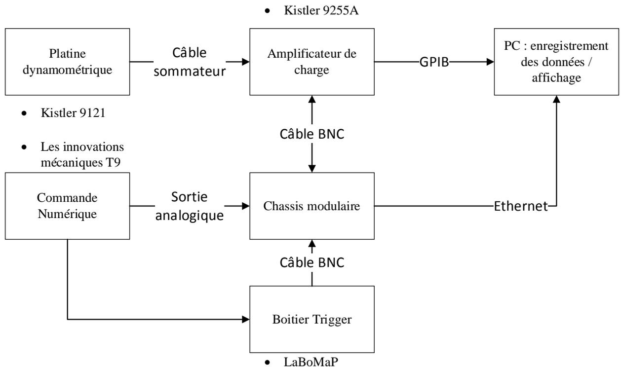
Figure B.1 : Chaîne d'acquisition mise en place pour les essais de tournage
