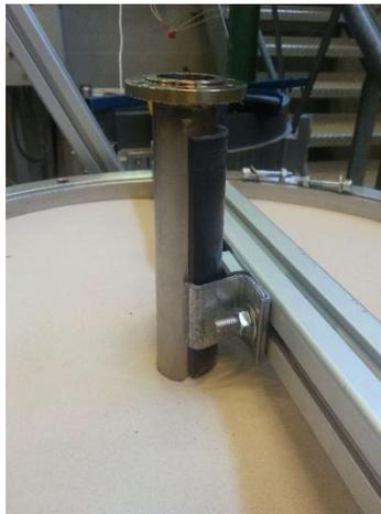
Figure 3.8 - Guide pour l'installation du pieu
