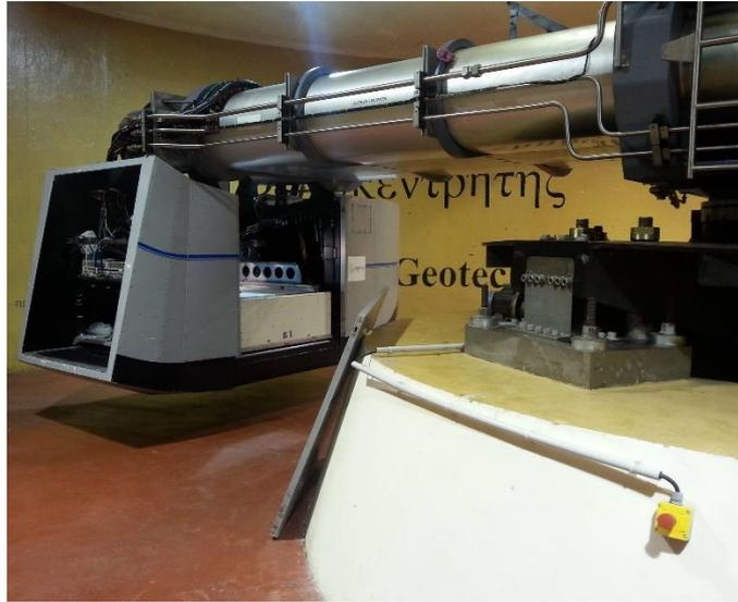
*Figure A.3 - Centrifugeuse du département GMG, centre IFSTAR de Nantes*
