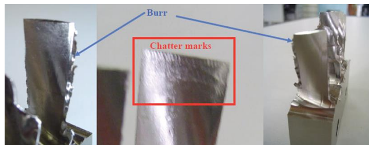
Figure 3 Surface d'une pièce usinée après une opération de fraisage
