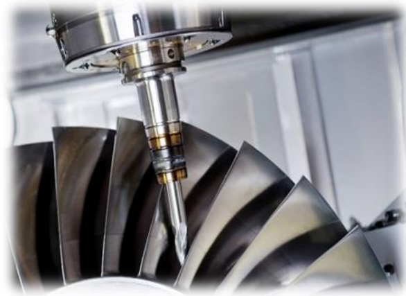
Figure 6 Usinage avec outil long
