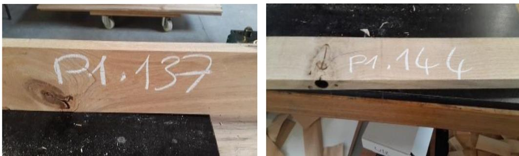
Figure 2.18 : Figure d'un nœud perpendiculaire à la face de la planche (gauche) et perpendiculaire à la rive de la planche (droit)
