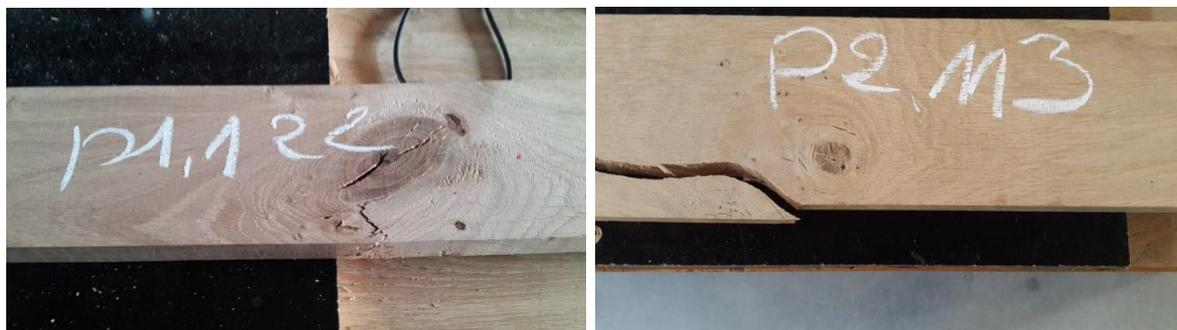
Figure 2.14: Photographie d'un nœud elliptique (gauche) et d'un nœud circulaire (droit)
