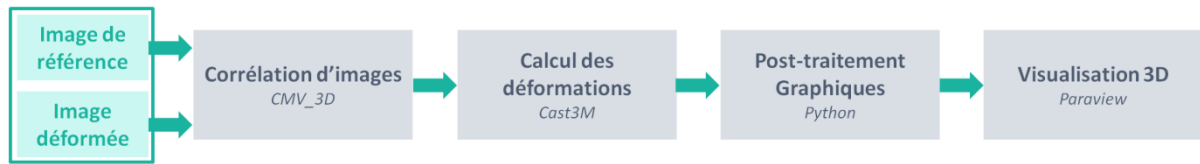
Figure 5.17 – Procédure de post-traitement des mesures de corrélation d'images volumiques.
