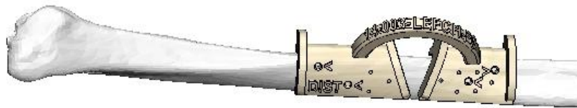
Figure 11 : Modèle 3D d'une fibula et d'un guide de coupe sur mesure, (Materialise France)
