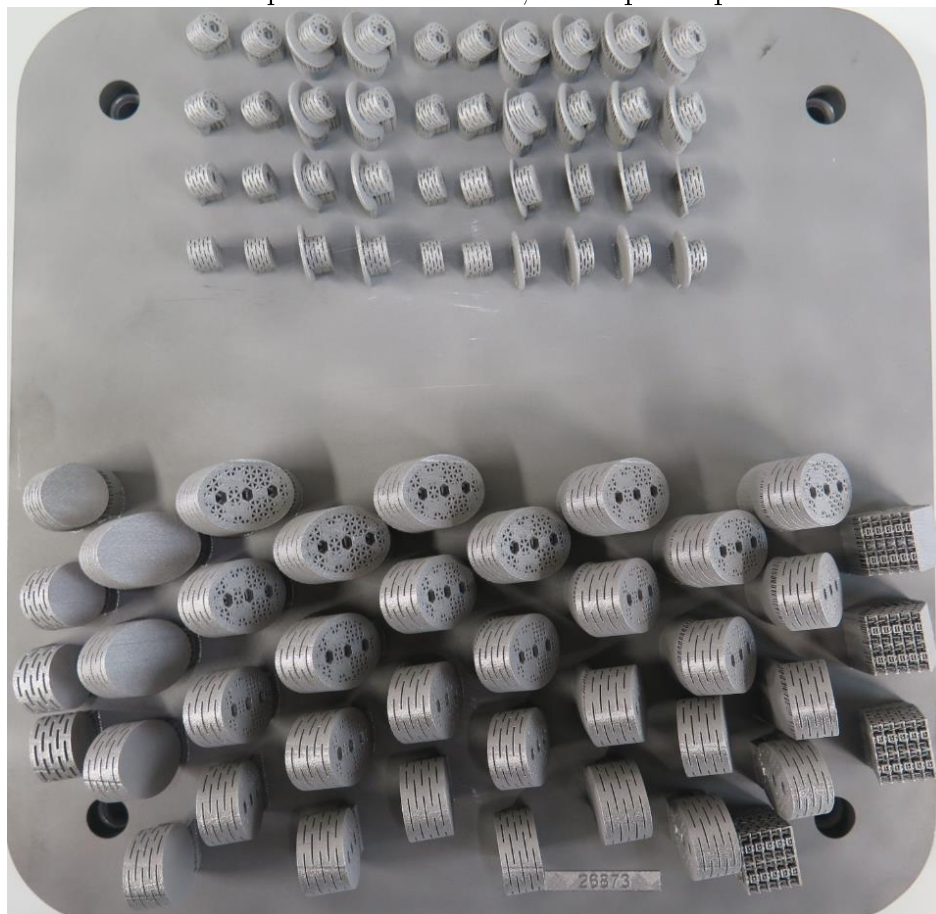
Figure 86 : Photographie de l'impression avant l'ablation des supports, sur la plaque d'impression
