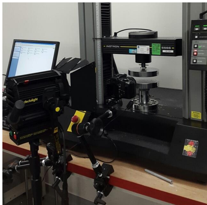
Figure 62 : Photographie de la mise en place des tests de compression des premiers prototypes
