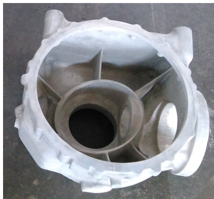
FIGURE 1 – Carter de boîte de transmission d'hélicoptère en alliage de magnésium RZ5 coulé par basse-pression
