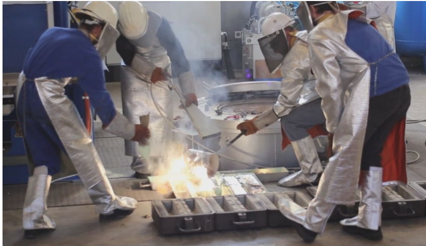
FIGURE 2 – Coulée d'un alliage de magnésium par gravité sur la plateforme technologique d'Aix-en-Provence montrant la forte oxydation du métal
