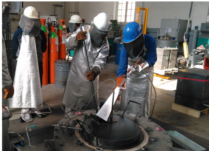
FIGURE 2.8 – Phase de brassage de l'alliage : l'opérateur brasse l'alliage protégé avec la lance par l'inertage au CO 2 + SF 6 provenant des bouteilles de pré-mélange à l'arrière plan.
