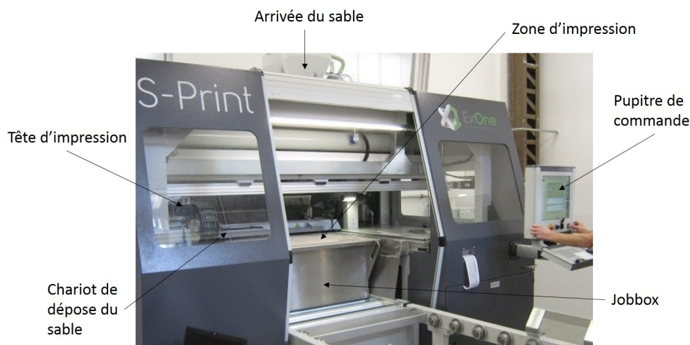
FIGURE 2.2 – Imprimante 3D au sable Exone de la plateforme LowCast des Arts et Métiers d'Aix-en-Provence
