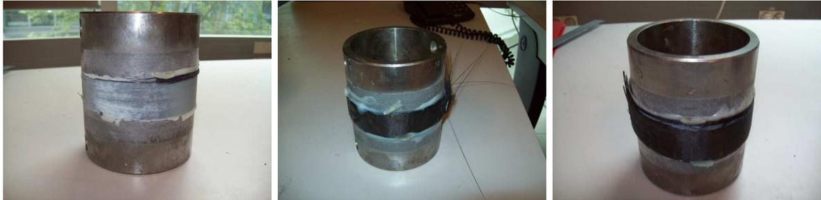
(a) Rupture cohésive dans la colle (b) Rupture du composite (c) Rupture mixte adhésive-cohésive
