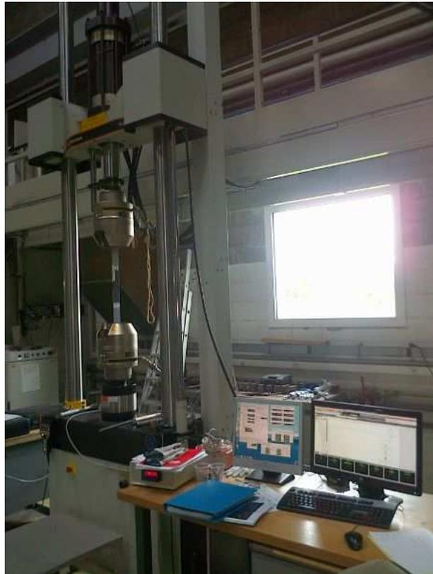
FIG. 6.7. Machine Instron de capacité 250 kN
