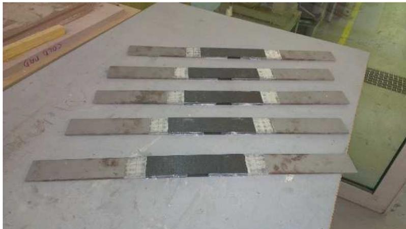
FIG. 6.6. *Les éprouvettes de fatigue prêtes à tester*
