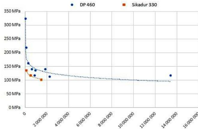
FIG. 6.11. La résistance en fatigue des joints collés à double recouvrement pour les deux types de colle, DP 460 élastoplastique et Sikadur 330 élastique fragile,  $R=0.1$
