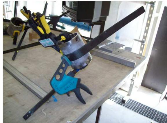
(d) Les éprouvettes en phase de séchage
