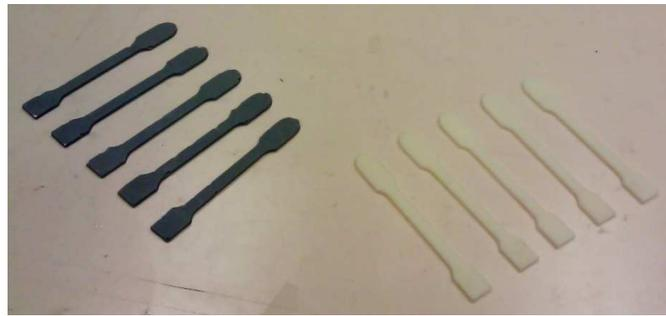
FIG. 3.18. *Éprouvettes de traction adhésif : 5 Sikadur 330 et 5 DP 460*
