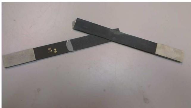
(b) Rupture adhésive à l'interface, éprouvette  $S2$
