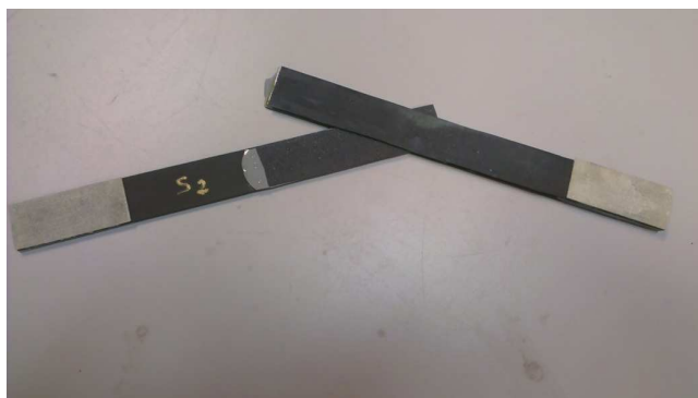
(b) Rupture adhésive à l'interface, éprouvette S2
