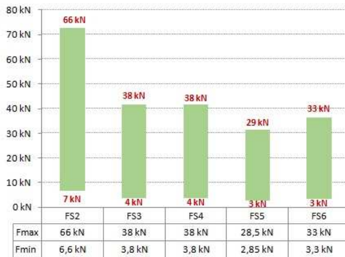
FIG. 6.10. La force appliquée sur les éprouvettes de Sikadur330, pour R=0.1
