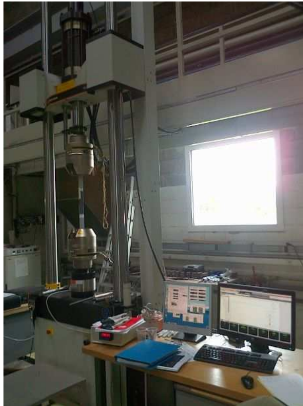
FIG. 6.7. Machine Instron de capacité 250 kN
