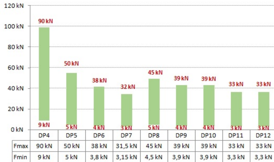
FIG. 6.8. La force appliquée sur les éprouvettes de DP460, pour R=0.1
