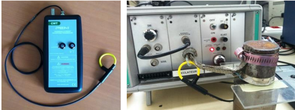
Figure 5.97 : Sonde RCWT Mini HF6 (gauche) et son utilisation sur le système d'émission du CETIM (droite).
