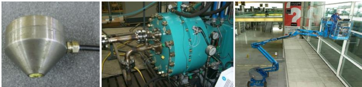
Figure 0.2 : Sonde EMAT bi-onde conçue au CETIM et exemples d'applications.
