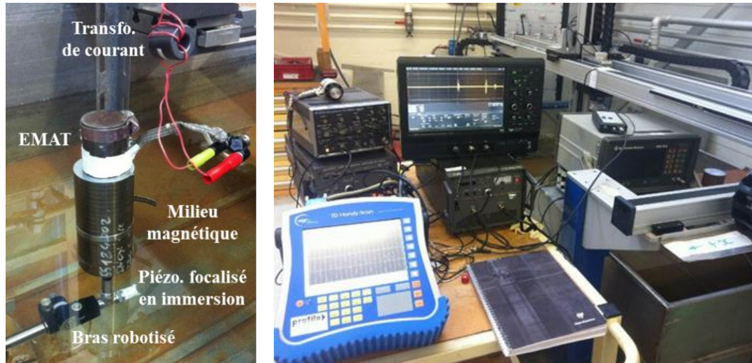
Figure 5.108 : Montage expérimental pour la caractérisation en cuve du champ ultrasonore transmis par EMAT dans une pièce ferromagnétique à l'aide d'un traducteur piézoélectrique focalisé en immersion.
