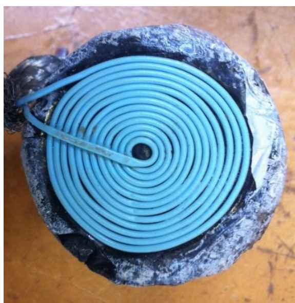
Figure 5.119 : Face active de l'EMAT didactique étudié après usage répété.
