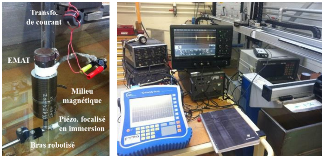
Figure 5.108 : Montage expérimental pour la caractérisation en cuve du champ ultrasonore transmis par EMAT dans une pièce ferromagnétique à l'aide d'un transducteur piézoélectrique focalisé en immersion.
