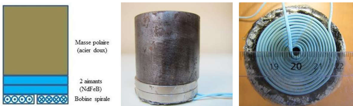
Figure 5.94 : EMAT didactique : Éléments constitutifs (gauche) ; Vue de profil (centre) ; Vue de dessus (droite).
