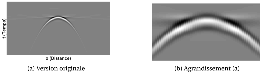
Figure 3.21: Présentation de la suppression du clutter pour le radargramme simulé à partir de la méthode du filtre de déclivité de la Figure 3.19.
