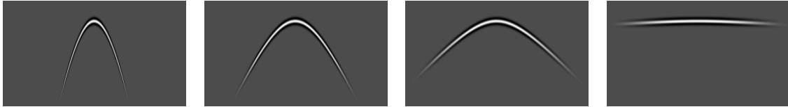
Figure 5.3: Exemple d'atomes composant le dictionnaire. Les trois premiers atomes permettront de décrire les formes hyperboliques du radargramme alors que le quatrième atome décrira le clutter.
