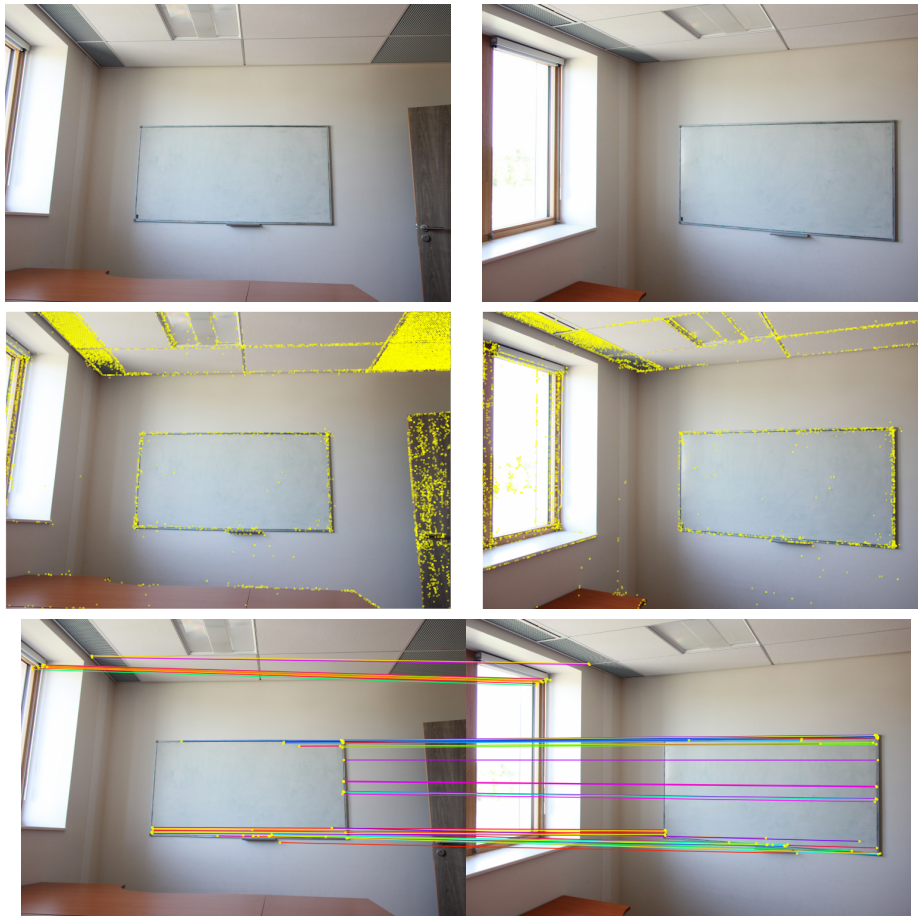
FIGURE 3.7 – Exemple de détection et d'appariement SIFT [46] de points saillants dans une scène d'intérieur. On remarque au passage l'un des problèmes des scènes d'intérieur puisque, si de nombreux points sont détectés, très peu sont mis en correspondance.
