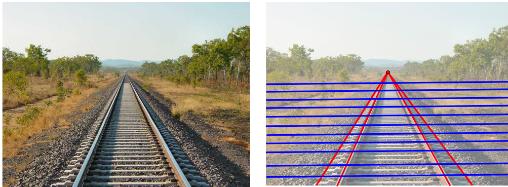
FIGURE 3.9 – Les lignes rouges suivent la direction des rails et sont parallèles dans la scène réelle mais concourantes dans le plan image (point rouge). Les lignes bleues suivent la direction orthogonale à celle des rails et sont toujours parallèles dans le plan image. Le point de fuite bleu est à l'infini .
