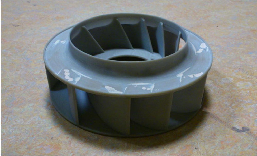
Figure 5-33 : Exemple d'une roue de ventilateur centrifuge à réaction testée
