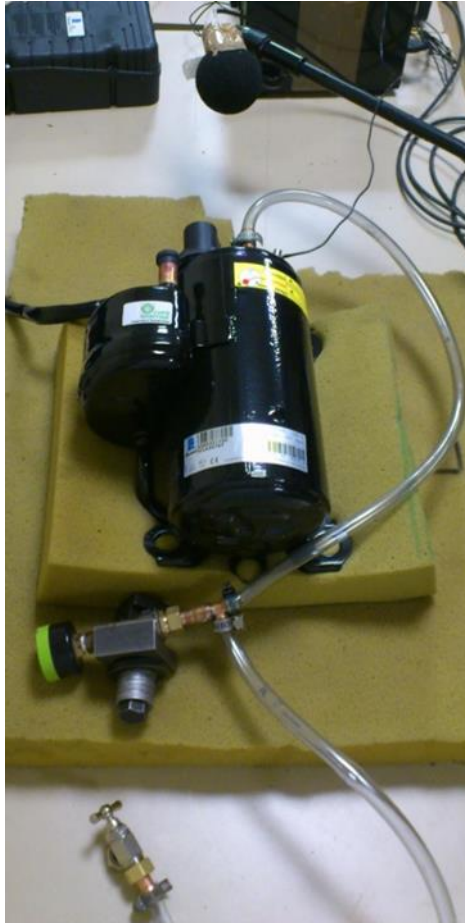
Figure 3-2: Conditions d'essai sur le compresseur horizontal au R134a
