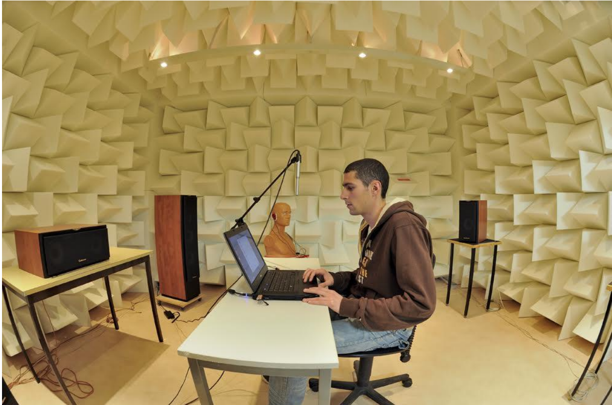
Figure 4-32 : Conditions de passage du test d'écoute dans la salle semi-anéchoïque
