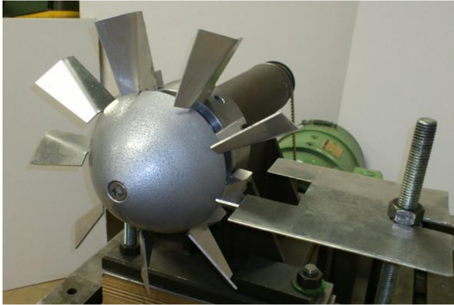
Figure 5-5 : Roue à pales courbées et obstacle réglable
