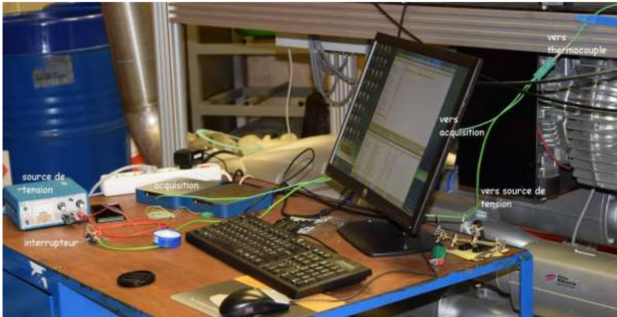
Figure 176 : Photographie du dispositif de chauffe par effet Joule
