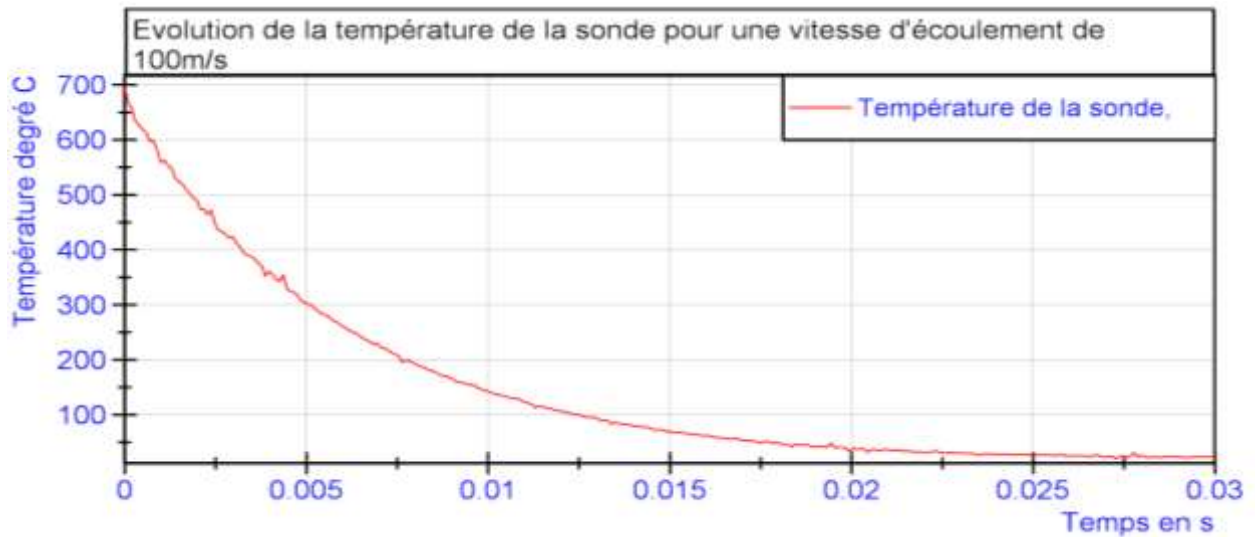
Figure 178 : Mesure du refroidissement du micro-thermocouple
