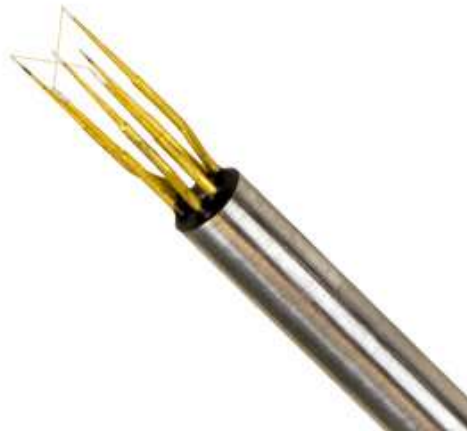
Figure 60 : Photo d'une sonde anémométrique à fils chauds croisés
