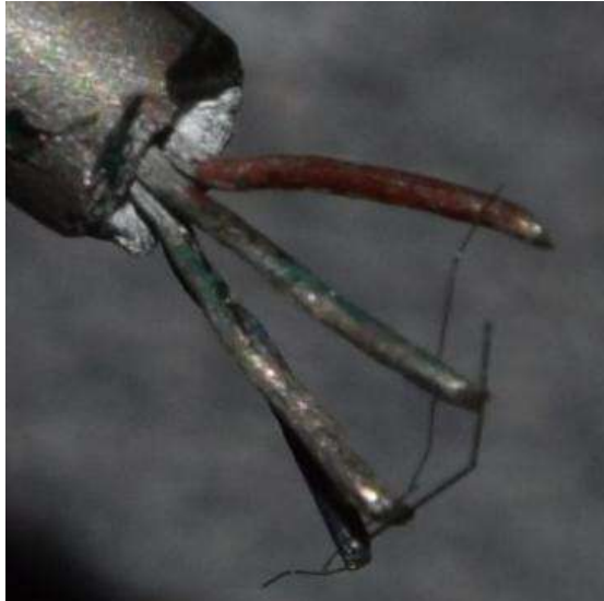
Figure 171 : Thermocouple de type K double composé d'un thermocouple soudé à l'aide de fils de 25 \mu\text{m} et d'un autre soudé à l'aide de fils de 50 \mu\text{m}
