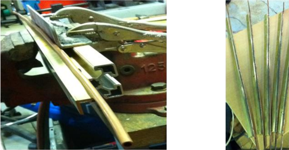
Figure IV-8 – Brasage tubes internes sur ailettes internes
