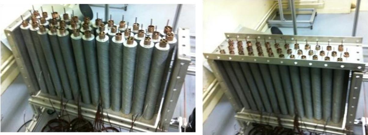
Figure IV-11 – L'échangeur complet sans les coudes et les collecteurs
