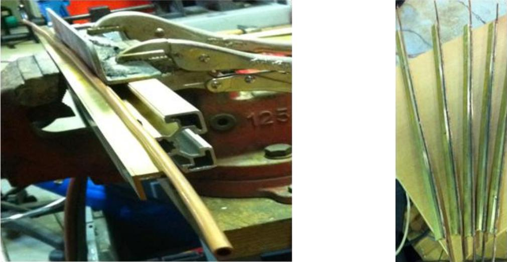
Figure IV-8 – Brasage tubes internes sur ailettes internes
