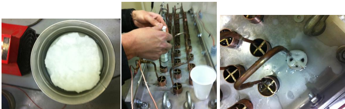
Figure IV-13 – Remplissage du MCP
