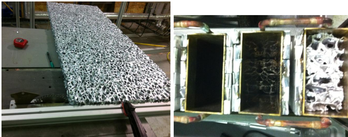
Figure IV-27 – Insertion de la mousse d'aluminium
