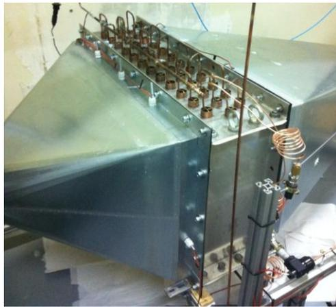
Figure IV-12 – L'échangeur complet avec le circuit frigorifique et les trémies d'air
