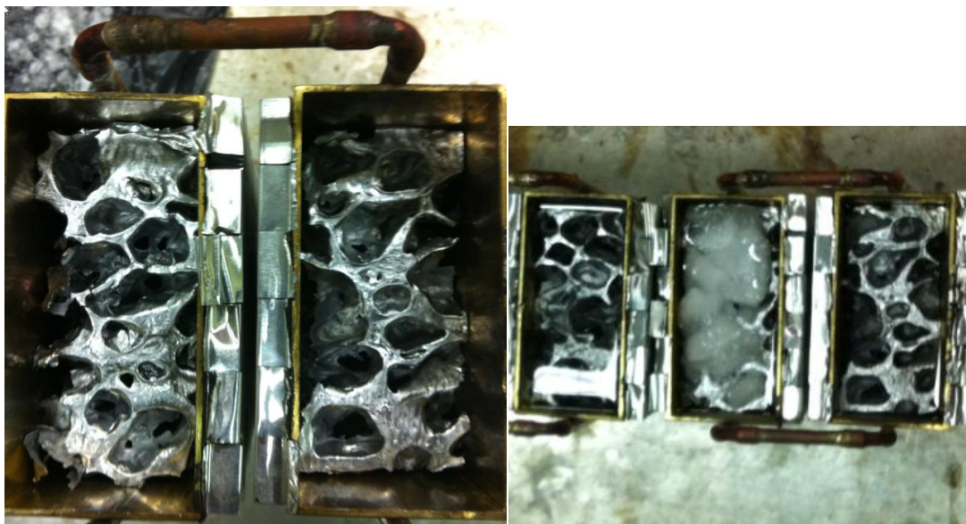
Figure IV-28 – Remplissage du MCP
