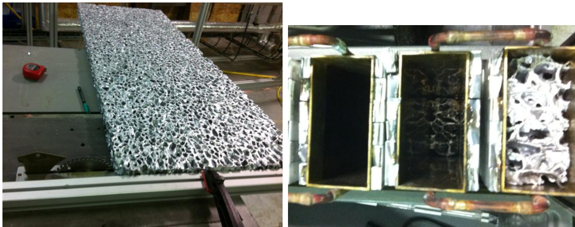
Figure IV-27 – Insertion de la mousse d'aluminium
