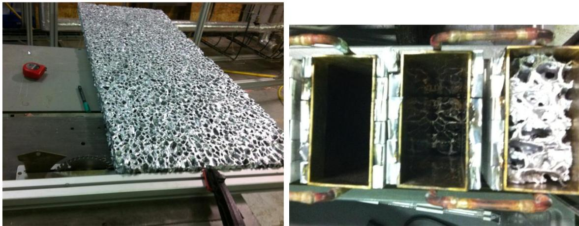
Figure IV-27 – Insertion de la mousse d'aluminium
