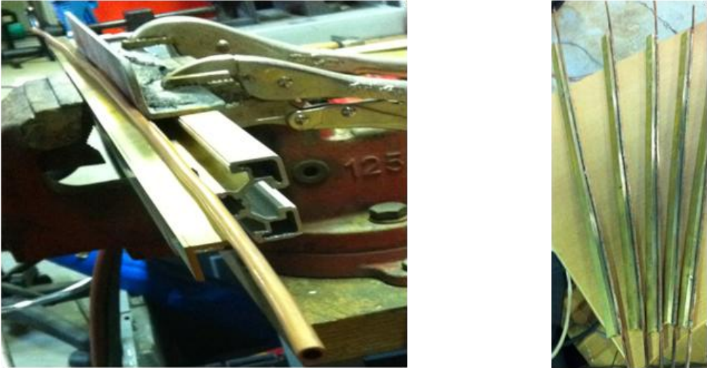
Figure IV-8 – Brasage tubes internes sur ailettes internes
