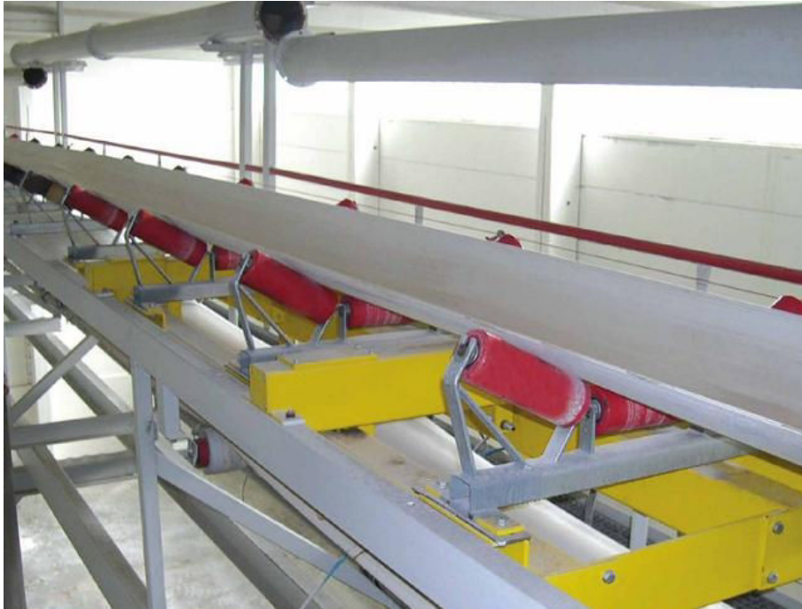
FIGURE 1.9 – Mise en auge d'une bande transporteuse à l'aide d'un système de rouleaux ©2016 COBRA Group.
