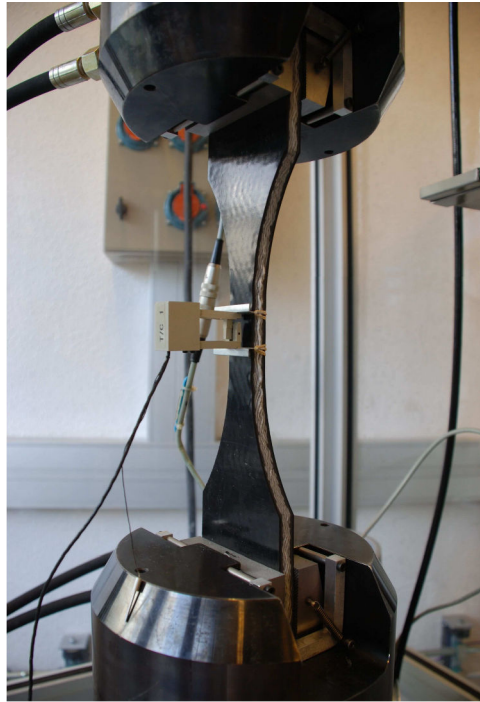
FIGURE 3.2 – Dispositif de serrage de l'éprouvette haltère avec ses deux mors hydrauliques [Piezel, 2010].
