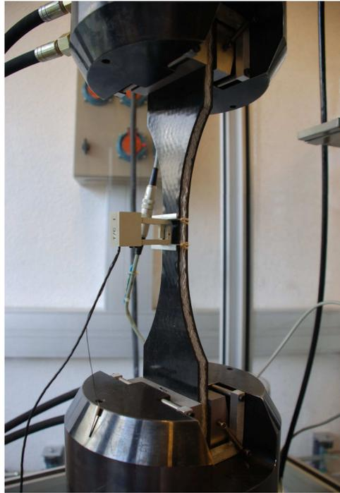
**FIGURE 3.2** – Dispositif de serrage de l'éprouvette haltère avec ses deux mors hydrauliques [Piezel, 2010].
