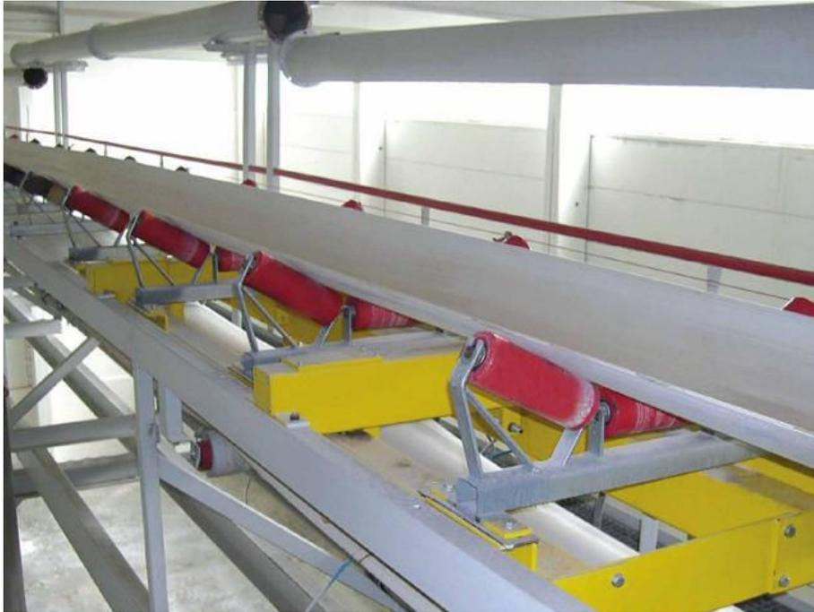
**FIGURE 1.9** – Mise en auge d'une bande transporteuse à l'aide d'un système de rouleaux
