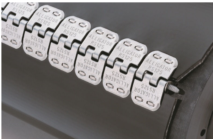
FIGURE 1.11 – Jonction de bandes transporteuses par agrafage.
