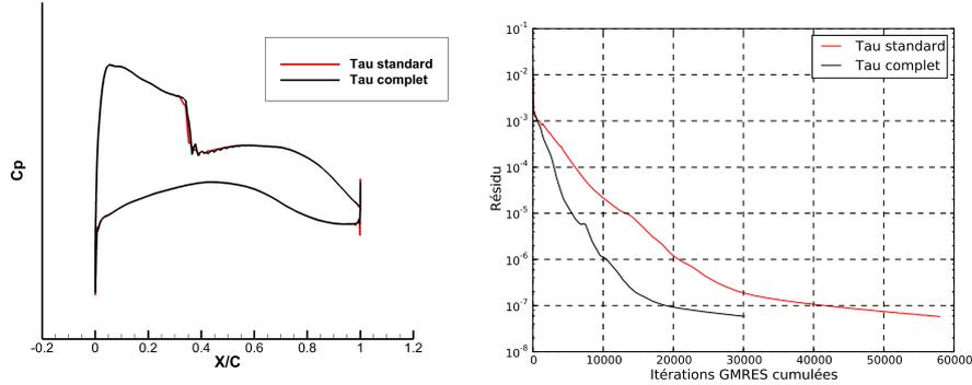
FIGURE 1.4 – À gauche, coupe de pression sur le cas Falcon croisière (cas test V). À droite, convergence du résidu non-linéaire en fonction du nombre cumulé d’itérations GMRES sur le cas Falcon décollage (cas test VI).
