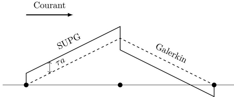
FIGURE 5.3 – Fonction test sur un élément pour la méthode de Galerkin et la méthode SUPG
