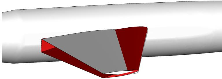
FIGURE 4.8 – Mode de tangage de voilure sur la maquette DTP (cas test II). Voilure déformée en rouge
