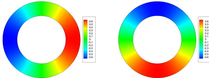
FIGURE 6.19 – Parties réelle (gauche) et imaginaire (droite) de la variation de pression en Pascal d'un mode (1,1) imposé dans le plan d'entrée
