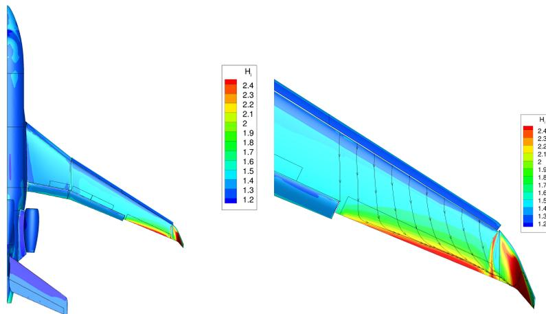
FIGURE 4.12 – Vue du facteur de forme incompressible  $H_i$  pour le cas Falcon décollage (cas test III). À droite, détail sur l'extrémité de l'aile et lignes de frottement indiquant le décollement de bord de fuite.
