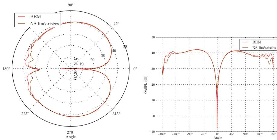
FIGURE 6.20 – Directivité en champ lointain d'un mode (1,1) à 2 kHz sans écoulement. Comparaison entre Navier-Stokes linéarisé et approche Helmholtz BEM.
