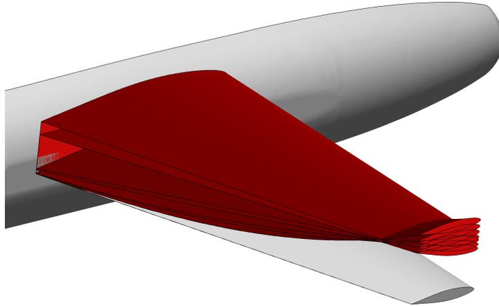
FIGURE 3.3 – Différents modes propres structuraux de la voilure de la maquette DTP
