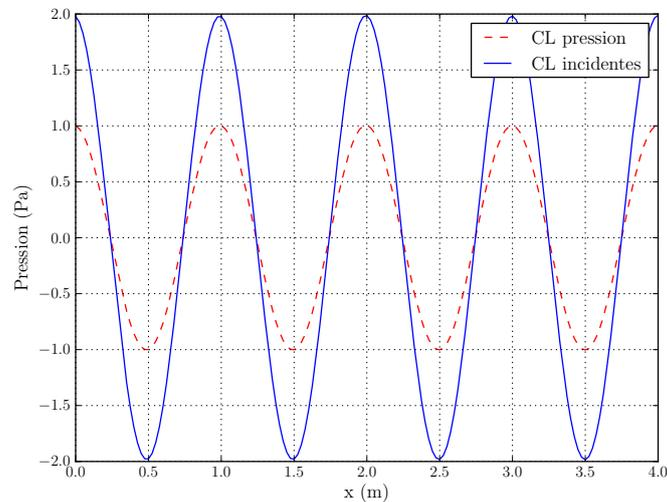
FIGURE 6.2 – Partie réelle de la variation de pression dans une cavité de 4 m de long. Onde plane à 340 Hz.
