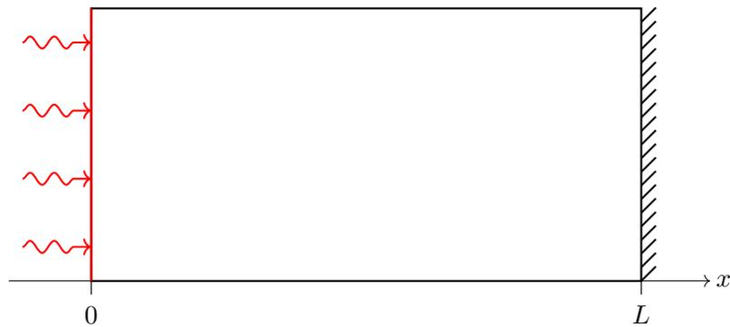
FIGURE 6.1 – Schéma de la cavité accordée. L'onde est injectée en  $x = 0$ .
