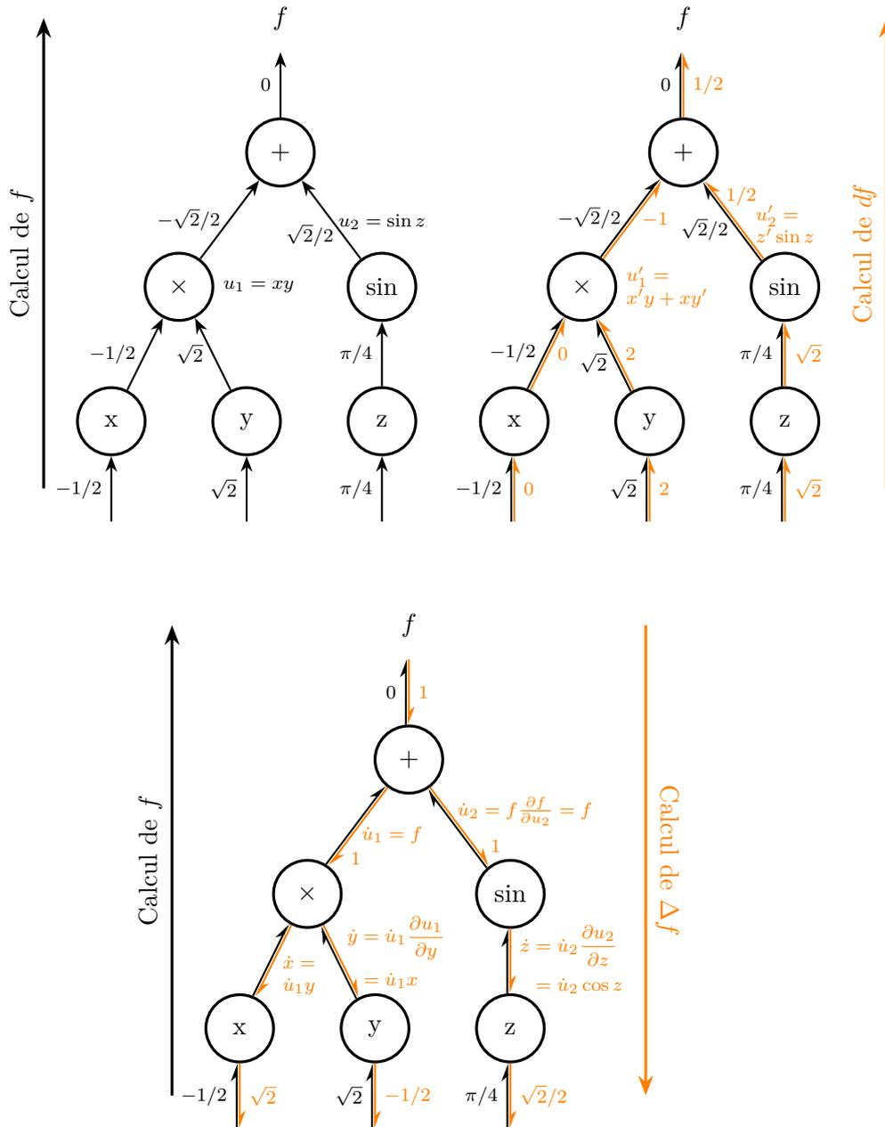
FIGURE 2.3 – En haut, calcul de  $f(x, y, z) = xy + \sin z$  à gauche et calcul de la dérivée directionnelle de  $f$  à droite. En bas, calcul du gradient de  $f$ . La notation  $\dot{x}$  réfère à la dérivée inverse de la variable d'entrée  $x$ . On consulera [76] pour des explications plus détaillées.
