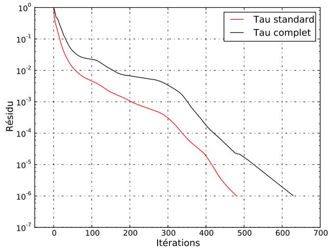
FIGURE 5.15 – Convergence du résidu normalisé par l'algorithme GMRES. Cas Falcon décollage linéarisé (cas test VII).
