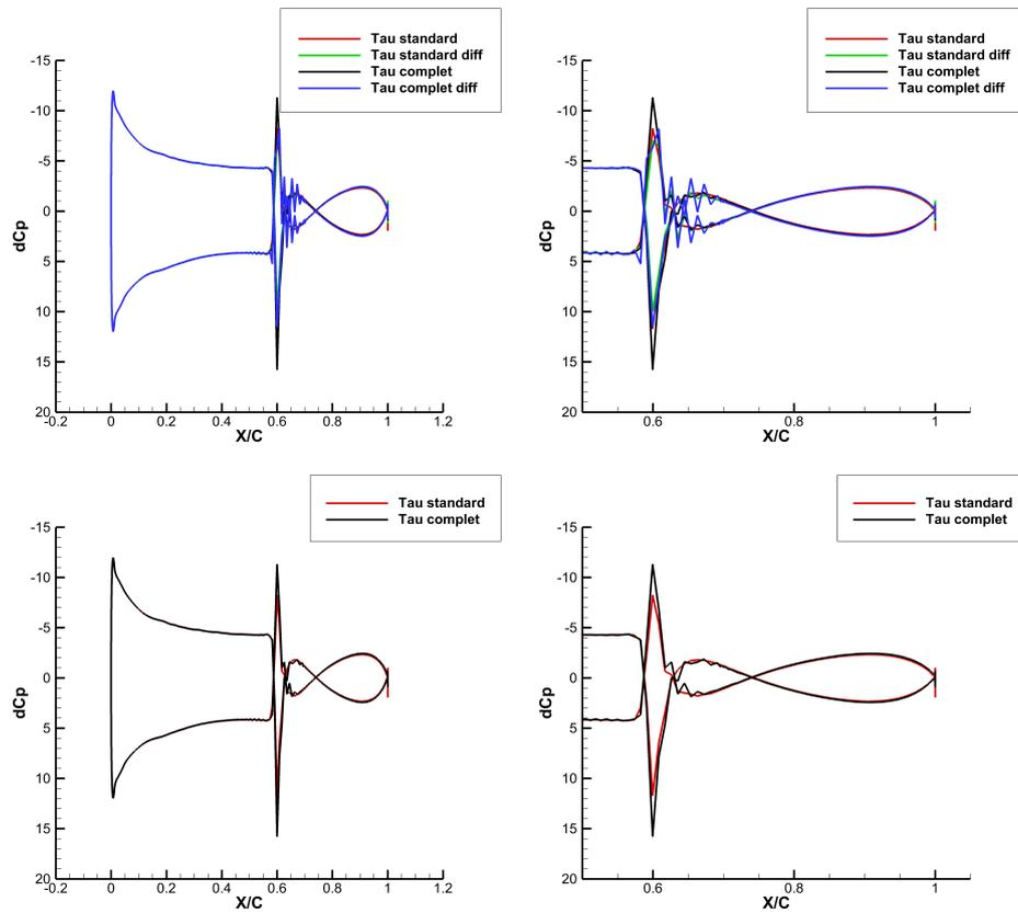
FIGURE 5.14 – Variation de la pression sur une coupe de l’aile. Cas DTP (cas test II). Ligne du bas : calculs sans  $\tau$  différencié. Ligne du haut : calculs avec  $\tau$  différencié. Colonne de gauche : coupe sur toute la corde de l’aile. Colonne de droite : zoom sur la partie antérieure de l’aile.
