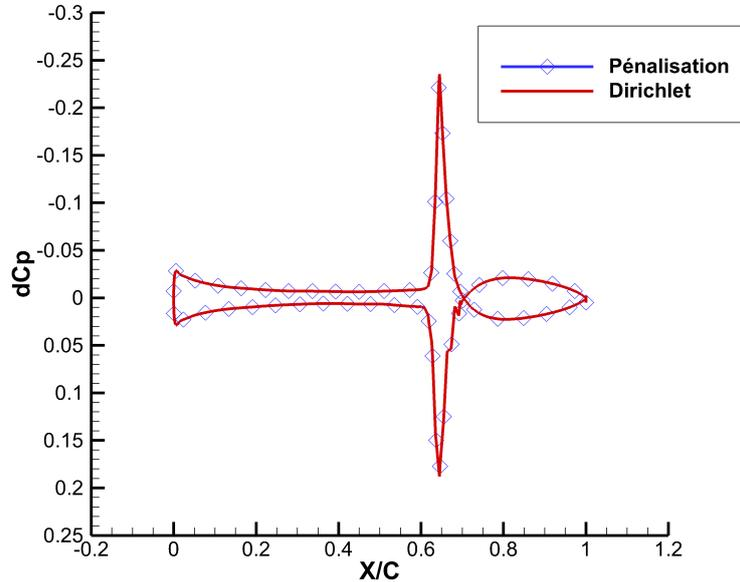
FIGURE 6.6 – Partie imaginaire du  $dC_p$  à mi-envergure de la maquette DTP pour un mouvement de tangage à 30 Hz à Mach 0,88. Imposition de la vitesse à la paroi par pénalisation ou par condition de Dirichlet non homogène.
