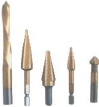
Figure I. 10. Exemples d'outils de coupe revêtus de TiN [45]
