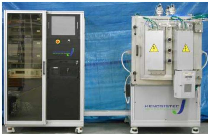
**Figure II. 4. Système de dépôts industriel KENOSISTEC modèle KS40V**
