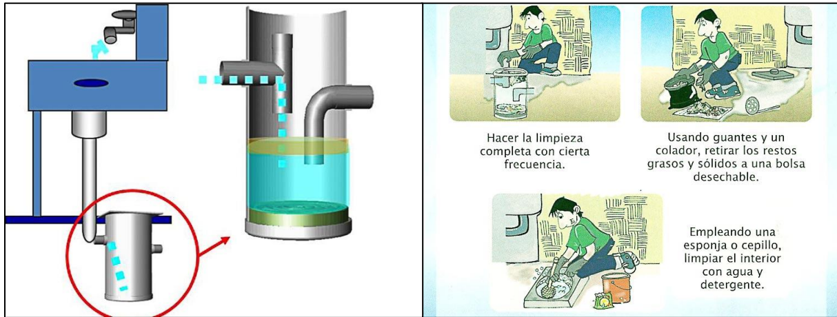
Figure 11/L. Fonctionnement du piège à graisse
