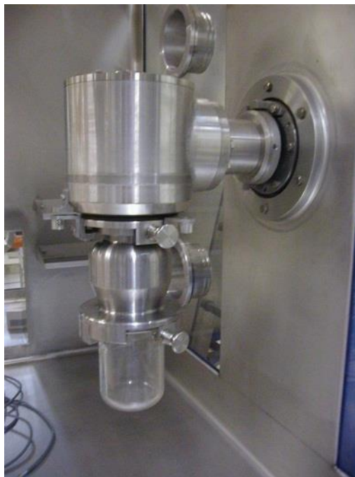
Figure 95: Broyeur à boulets nucléarisé présent au LEFCA
