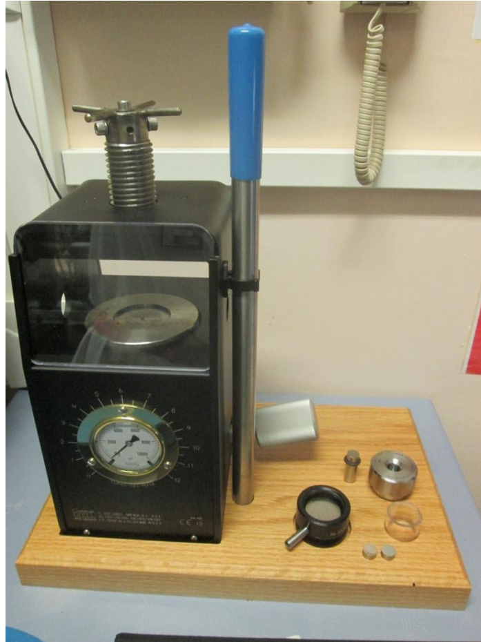
Figure 47: Presse manuelle utilisée au L18 sur Atalante pour le pressage des poudres de stéarate de zinc et d'acide stéarique
