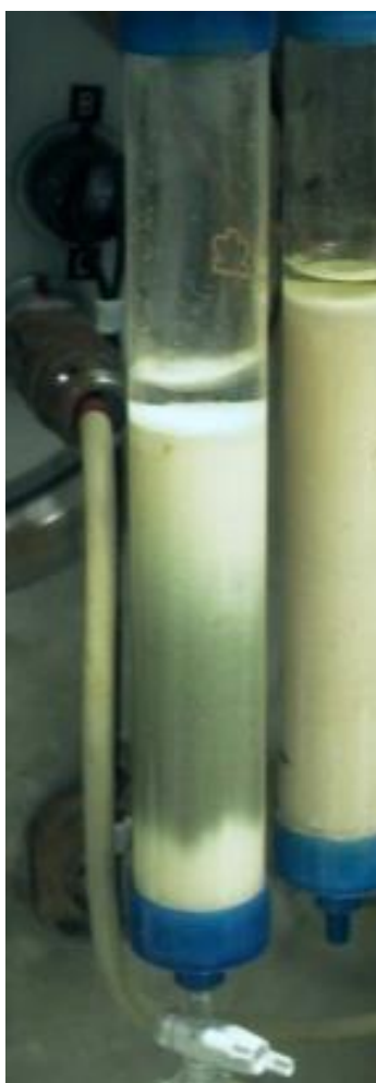
Figure 137: Colonne de purification avec du plutonium adsorbé
