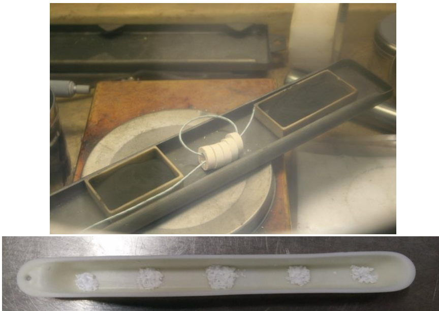
Figure 113 : Nacelles de calcination utilisées au LEFCA (en haut) et au Laboratoire UO 2 (en bas)
