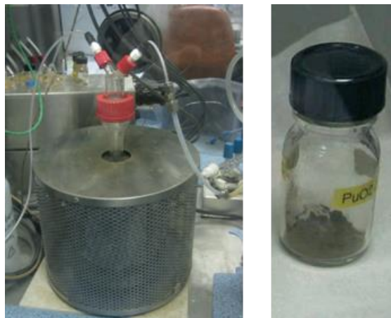
Figure 139: Four avec ampoule de calcination (à gauche) et poudre finale \text{PuO}_2 (à droite)
