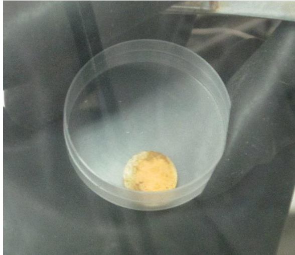
Figure 68: Pastille de stéarate de zinc irradiée au contact de \text{PuO}_2
